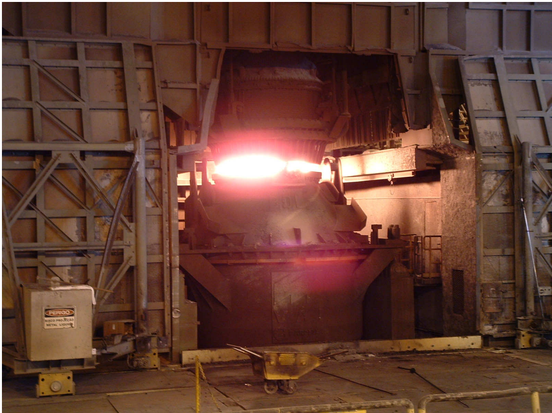
Figura 4.4 – Conversor AOD-L de 80t da Acesita S.A..
