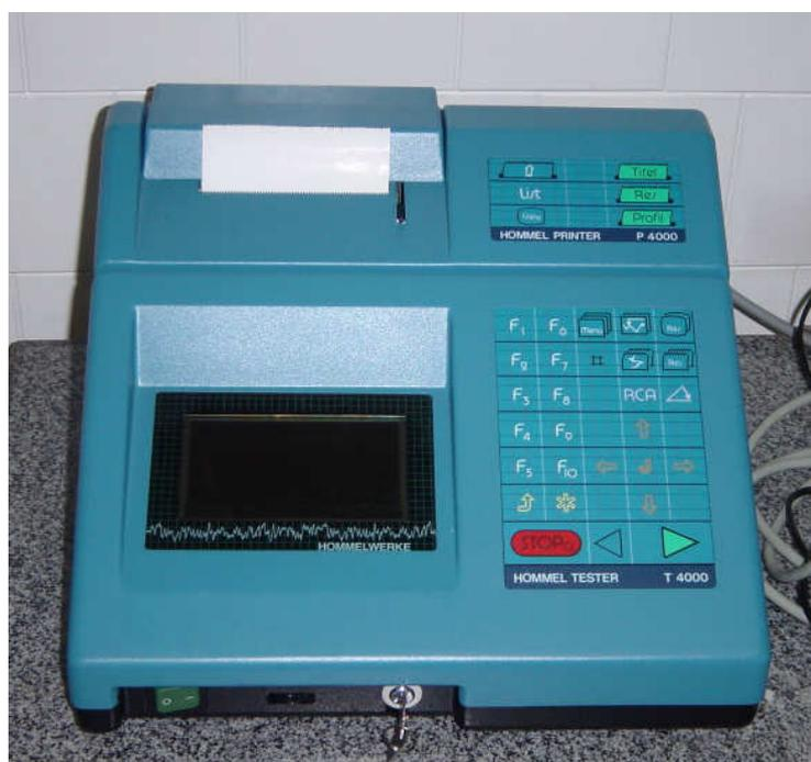
Figura 4.9. Registrador do perfilômetro
