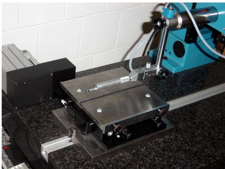
Figura 4.8. Perfilômetro - detalhe da ponta e mesa de medição.
