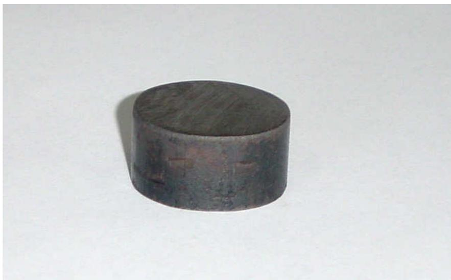
Figura 4.2. Foto de uma amostra com o recobrimento Duplex.
