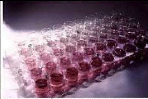
Bandeja com béqueres para teste de toxicidade crônica. O gradiente mostra a diluição da amostra, até o controle incolor.
