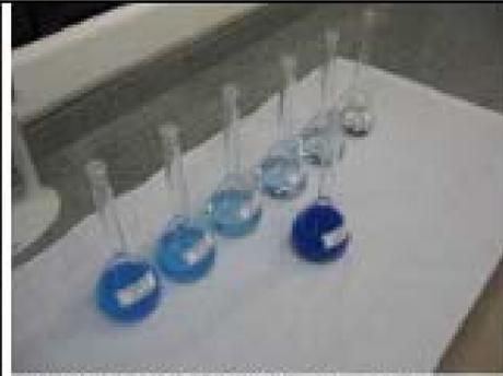
Solução "mãe" e soluções-teste, com diferentes concentrações de cobre
