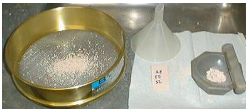
Figura 4.7 – Preparação da amostra para ensaio de picnometria de hélio
