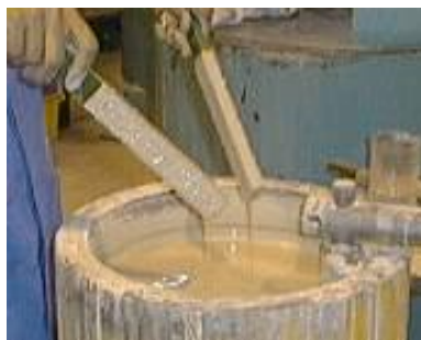
Figura 4.3 – Escoamento do excesso de lama após imersão das barras de cera
