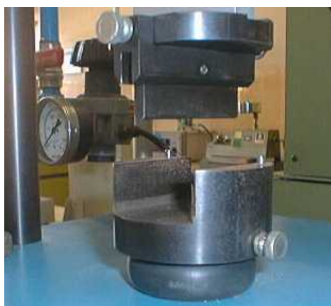
Figura 4.6 – Suporte para os corpos de prova e barra para aplicação transversal da carga
