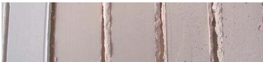
Figura 4.5 – Superfície dos corpos de prova das 1 a , 2 a , 3 a , 5 a e 7 a camadas (esquerda para a direita)
