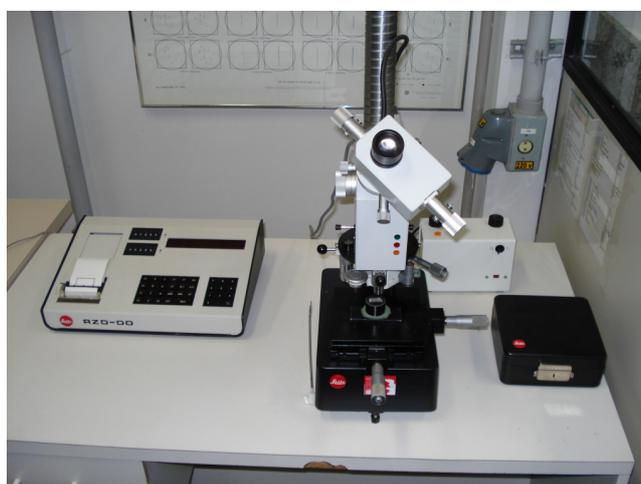
Figura 4-6 – Microdurômetro.
