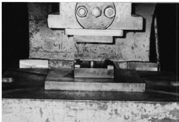
Figura 5.38 - Estampo utilizado para calibração do tarugo inicial.
