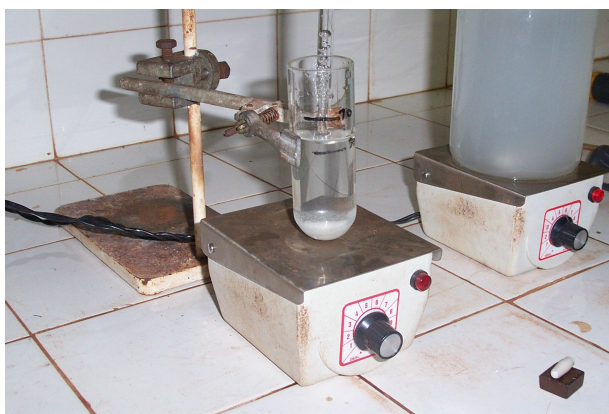
Figura 4.7 – Acerto do volume de teste (retirada do sobrenadante)
