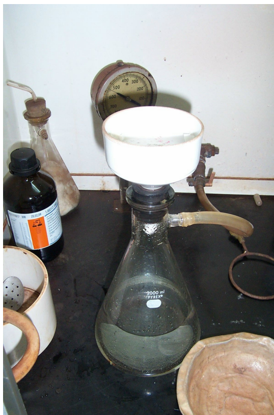
Figura 4.11 – Filtragem do flutuado e afundado
