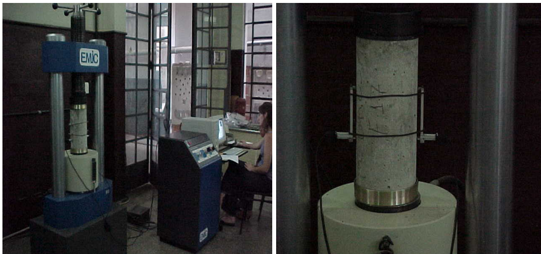
Figura 4.11 Prensa universal de ensaios EMIC – PC200, computadorizada, utilizada na determinação do módulo de elasticidade estático
