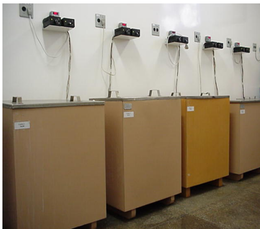
Figura 5.1 – Reatividade potencial dos agregados: conjunto de tanques
