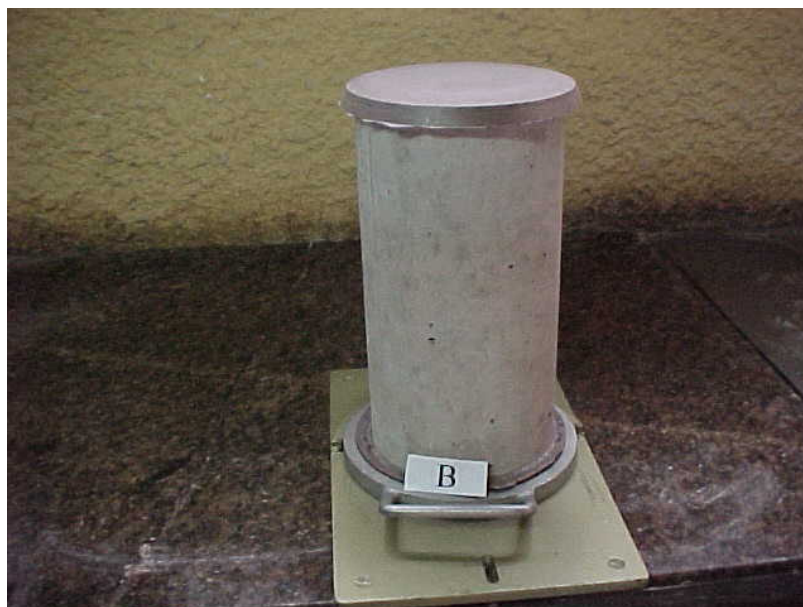
Figura 4.6 Capeamento dos corpos-de-prova cilíndricos
