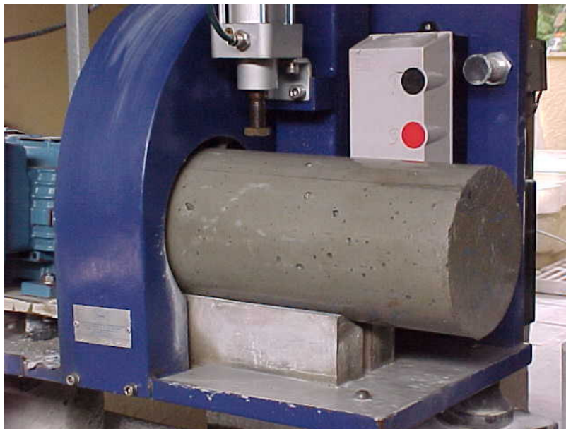
Figura 4.5 Retífica dos corpos-de-prova cilíndricos
