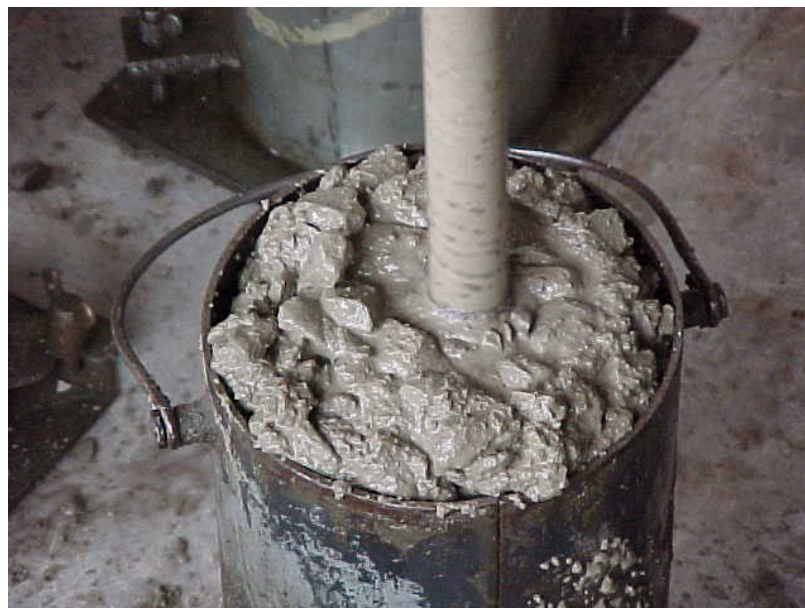
Figura 4.3 Adensamento dos corpos de prova cilíndricos 150x300 mm
