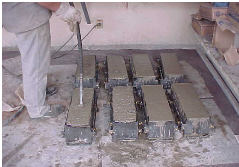
Figura 4.4 Adensamento dos corpos de prova prismáticos 150x150x500 mm
