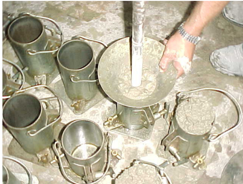
Figura 4.2 Adensamento dos corpos de prova cilíndricos 100x200 mm
