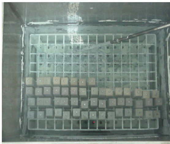
Figura 5.2 - Reatividade potencial dos agregados: vista interna do tanque
