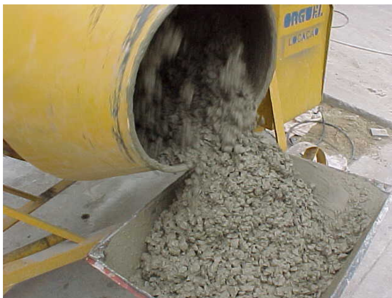
Figura 4.1 Betoneira eixo inclinado, capacidade 320 litros
