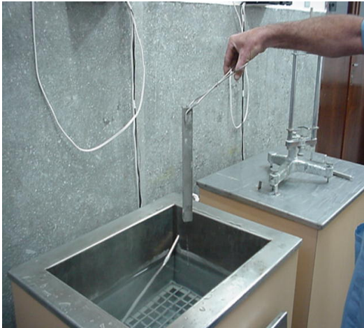
Figura 5.3 - Reatividade potencial dos agregados: retirada da barra
