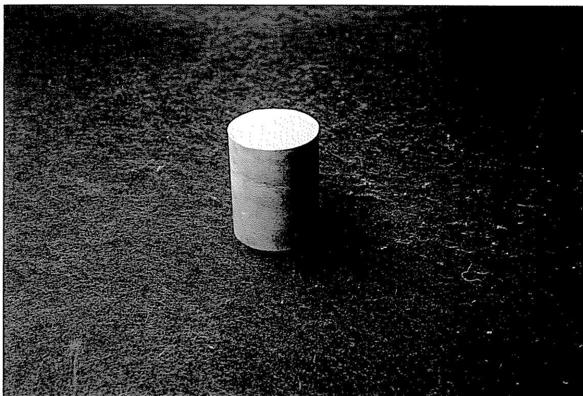
Figura 4.8-Corpo de prova de plasticina a ser usado em ensaio de cone truncado.
