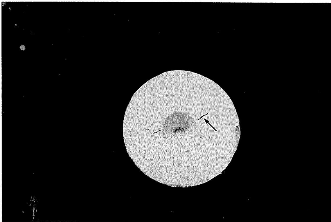
Figura 5.2-Corpo de prova de plasticina apresentando trinca do tipo  $\eta$ .
