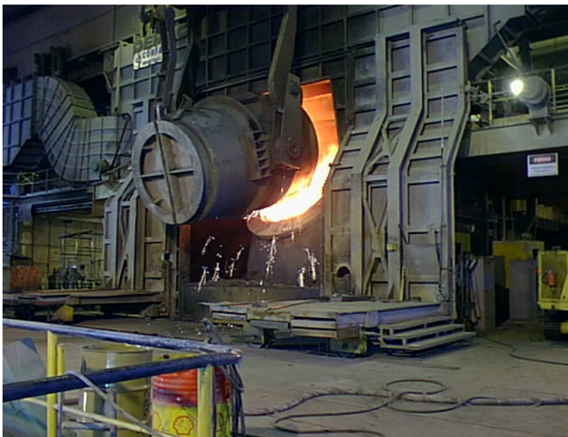
Figura 3.2 – Fase de Carregamento do processo MRP-L (Controle de Processo da Aciaria)
