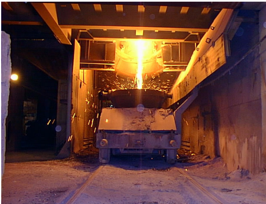
Figura 3.5– Fase de vazamento no processo MRP-L (Controle de Processo da Aciaria)
