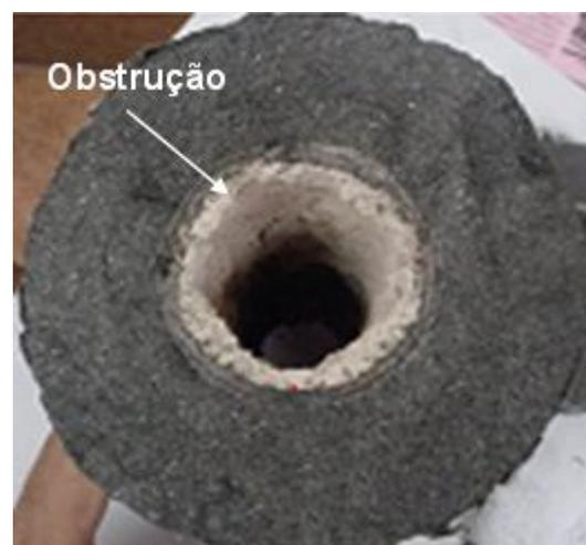
Figura 4.2 – Válvula submersa, com destaque para a obstrução parcial (material de coloração mais clara). (Documentos internos da ArcelorMittal Inox Brasil, 2007).
