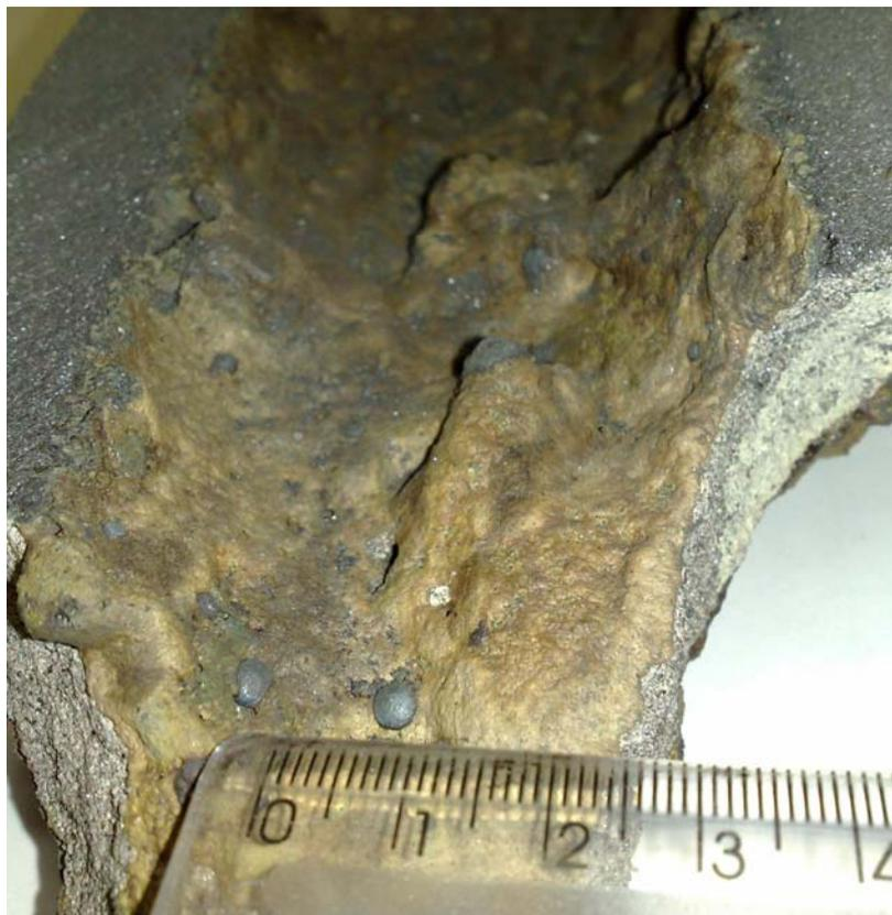
Figura 5.1 – Válvula submersa com obstrução parcial durante o lingotamento do aço P409A.
