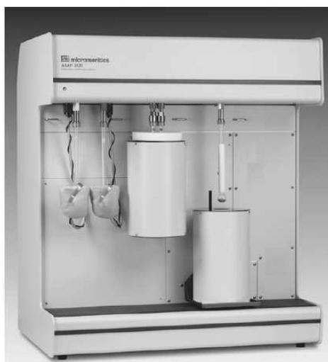
Figura 5.1 – Fotografia do aparelho utilizado para os ensaios de adsorção com N<sub>2</sub> (manual de operação do modelo ASAP 2020).
