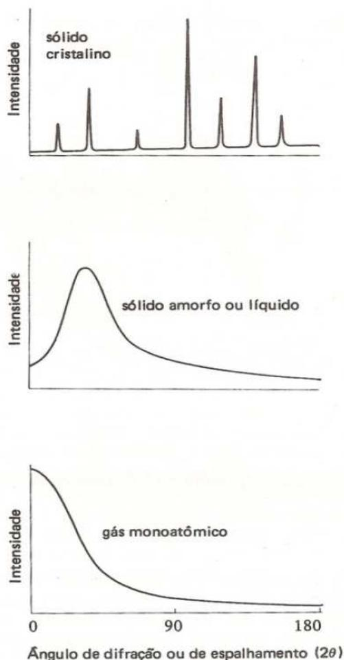
Figura 3.24 - Espectro típico característico de um material cristalino, de um líquido ou sólido amorfo e de um gás monoatômico, de acordo com PADILHA, *et al.* (1985).
