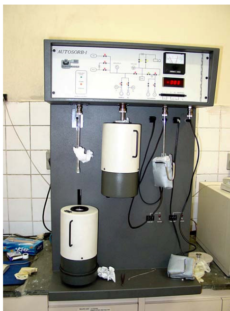
Figura 3.11 - Equipamento para a determinação da área específica por adsorção de nitrogênio através do método BET.
