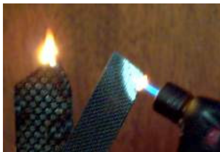
Figura 3.18 – Um compósito de carbono-epóxi está em chamas (esquerda) enquanto um compósito de carbono-geopolímero (direita) ainda resiste ao fogo de 1200° C.
