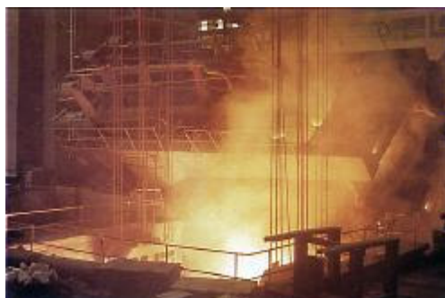
Figura 3.15 – Indústria Pehiney, EUA, desenvolveu e utiliza o geopolímero refratário para o lançamento de ligas de alumínio/lítio a altas temperaturas.
