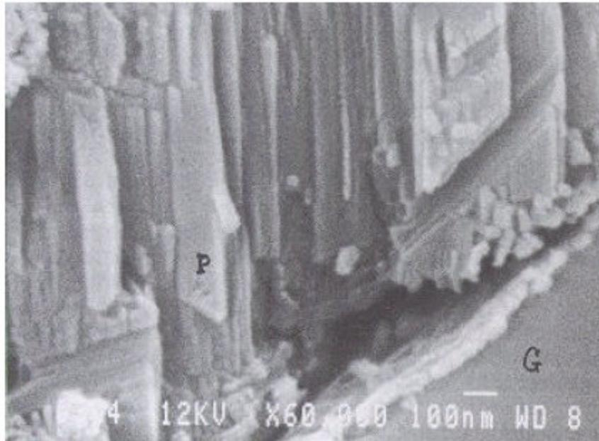
Figura 3.4- Cristais grandes de Portlandita (P) orientados perpendicularmente em relação ao agregado (G) na zona de transição (MORANVILLE E REGOURD, 1992)
