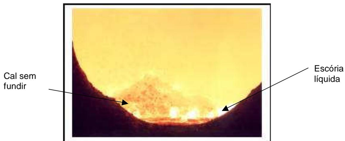
Figura 5.7 - Foto do banho aos 2 min de sopro (condição "A")
