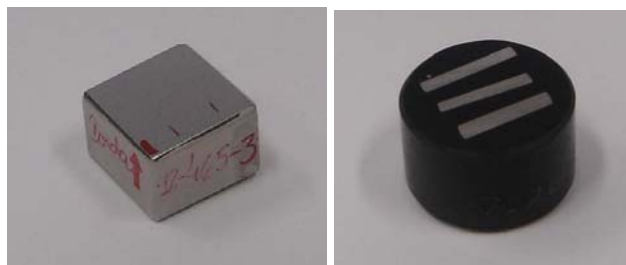
Figura 5.1 Amostras para análise na microscopia ótica proveniente do laminador desbastador (esquerda) e da tira após laminação de acabamento (direita).
