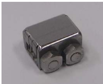
Figura 5.6 Amostras montadas para análise na microscopia eletrônica de varredura (MEV).
