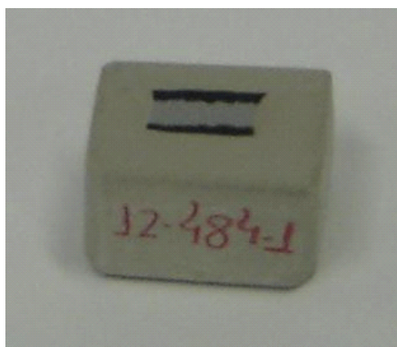
Figura 5.11 Amostra proveniente do ensaio de torção a quente embutida para análise na microscopia eletrônica de varredura (MEV) e posterior análise na microscopia ótica.
