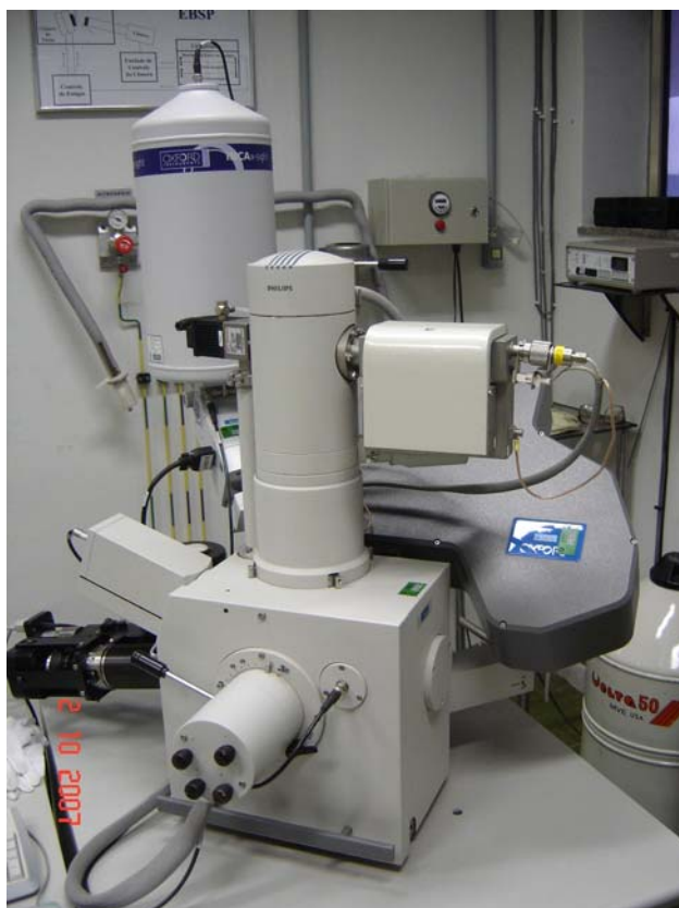
Figura 5.7 Microscópio eletrônico de varredura do laboratório de métodos físicos do Centro de Pesquisas da ArcelorMittal Inox Brasil.
