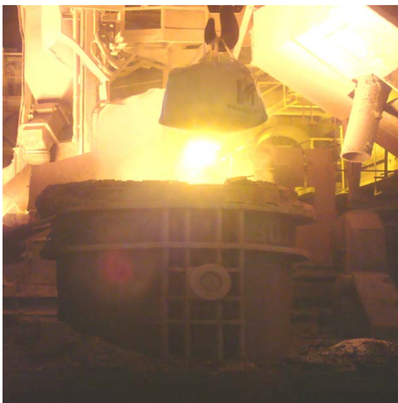
Figura 4.18 – Adição de escória sintética em bag e ponte rolante.
