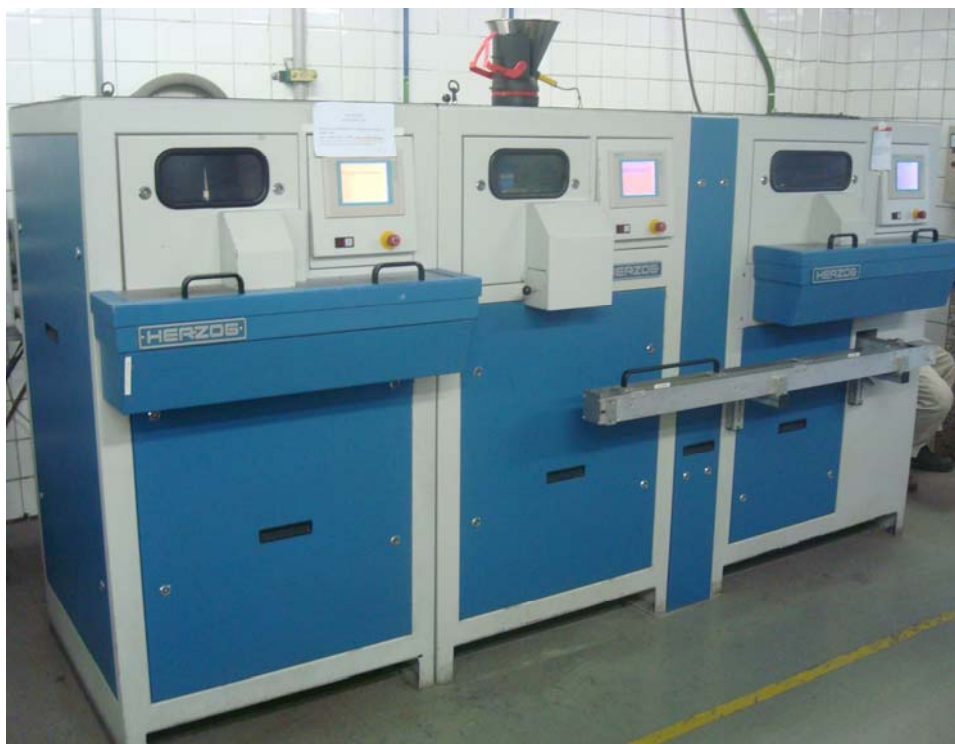
Figura 4.24 – Máquina de preparação de escória para análise química.
