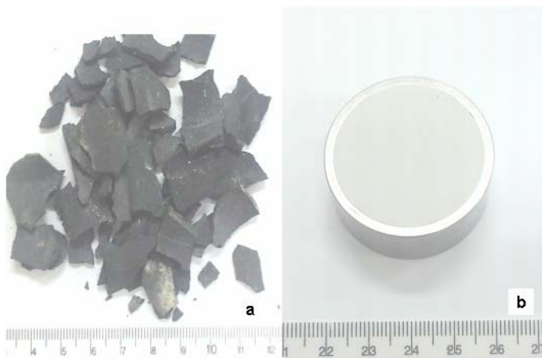
Figura 4.25 – Preparação da amostra de escória para análise, onde: (a) antes da preparação e (b) após a preparação.
