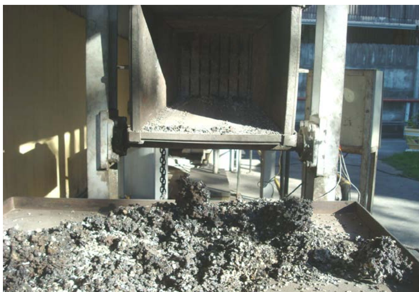
Figura 4.9 – Remoção da escória sinterizada do forno.
