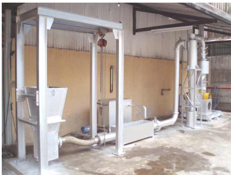
Figura 4.5 – Forno piloto sinterizador da Vamtec S/A.
