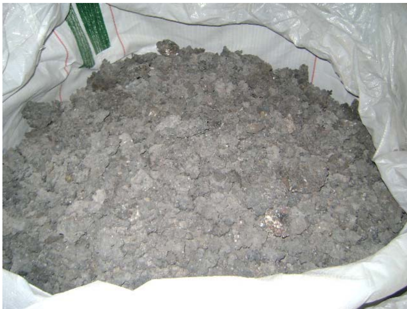
Figura 4.14 – Escória sinterizada, britada e peneirada.
