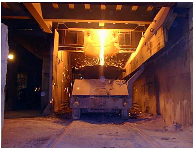
Figura 4.17 - Vazamento no convertedor MRPL.
