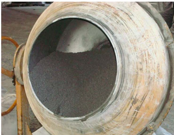
Figura 4.4 – Mistura da massa sintética
