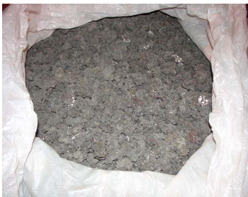
Figura 4.11 – Escória sinterizada após briquetagem e peneiramento.
