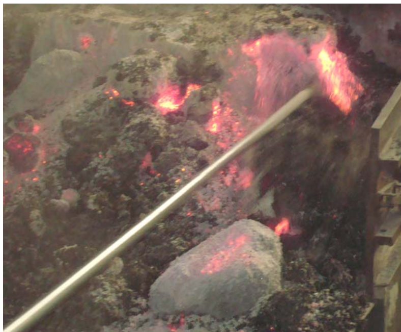
Figura 4.12 – Sinterização em escala industrial (Vê-se uma pá arrastando a escória).
