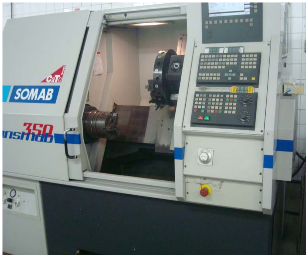
Figura 4.26-Torno CNC para remoção da camada de oxido da amostra de aço.
