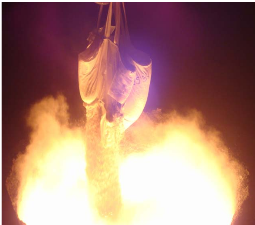
Figura 4.19 – Adição de escória sintética em bag e ponte rolante.
