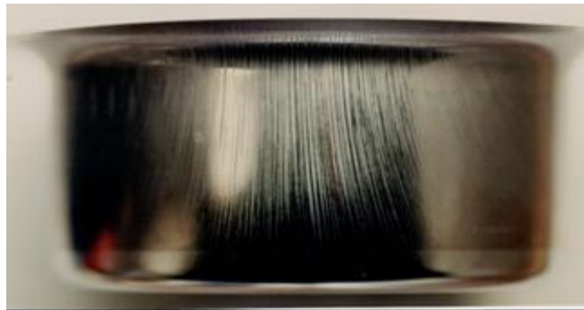
Figura 3.9 - ilustração do “ridging” – estrias típicas de um aço inox ferrítico na parede lateral de uma cuba retangular. Aço AISI 430, espessura 0,60mm (13) .
