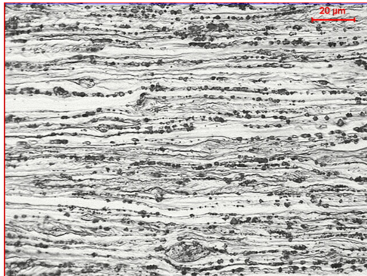
Figura 5.17 - Microestrutura do aço 430J contendo 21% de martensita após laminação a frio.
