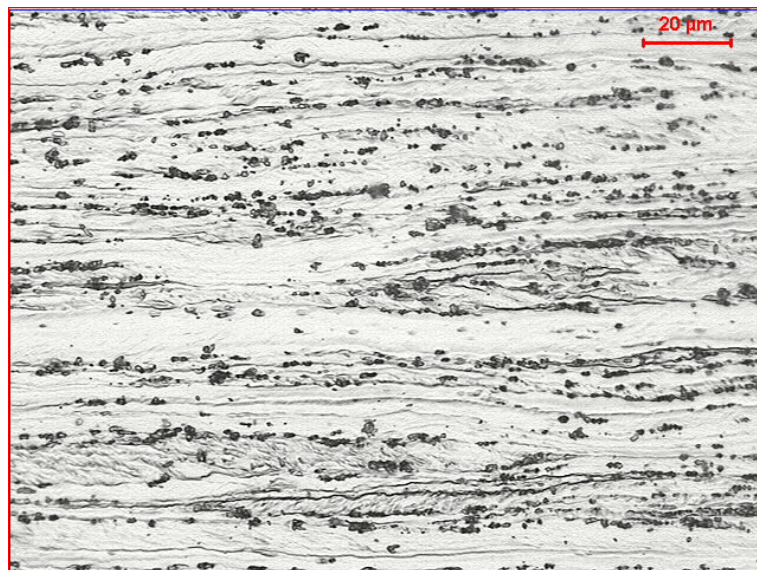
Figura 5.18 - Microestrutura do aço 430J contendo 0% de martensita após laminação a frio.
