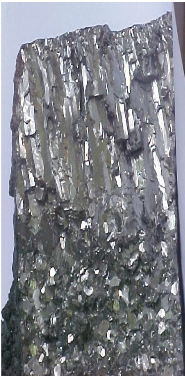
Figura 3.5 - Macroestrutura observada na seção transversal de uma placa de aço AISI 430 estabilizado ao Nb.
