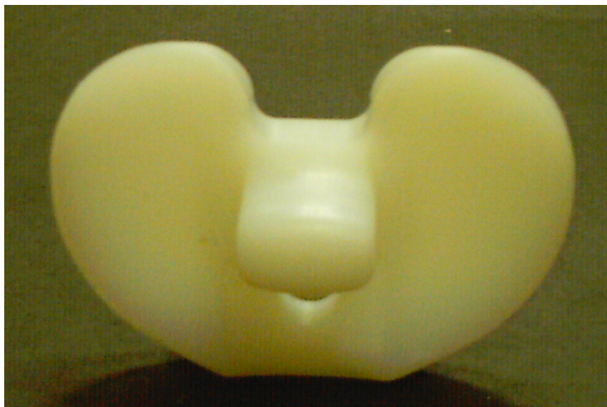
Figura 1.2: Vista inferior do UHMWPE utilizado em prótese de joelho.
