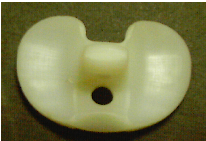
Figura 1.1: Vista superficial do UHMWPE utilizado em prótese de joelho.
