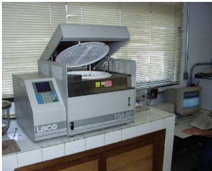
Figura 4.13 - Equipamento LECO TGA 601
