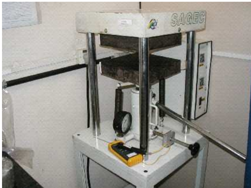
Figura 4.3 – Prensa SAGEC capacidade 15 Ton.
