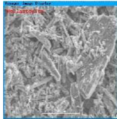
Figura 5.30 - (a) Fibras Silexil e (b) Fibras de vidro analisadas por MEV como recebidas (aumento 1500 X).
