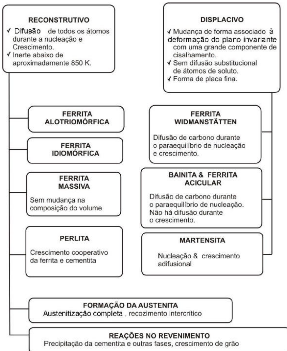
Figura 3.5 Mecanismos displacivo e reconstutivo para as principais transformações de fase nos aços ( BAINITE IN STEELS, Bhadeshia, 2001) .
