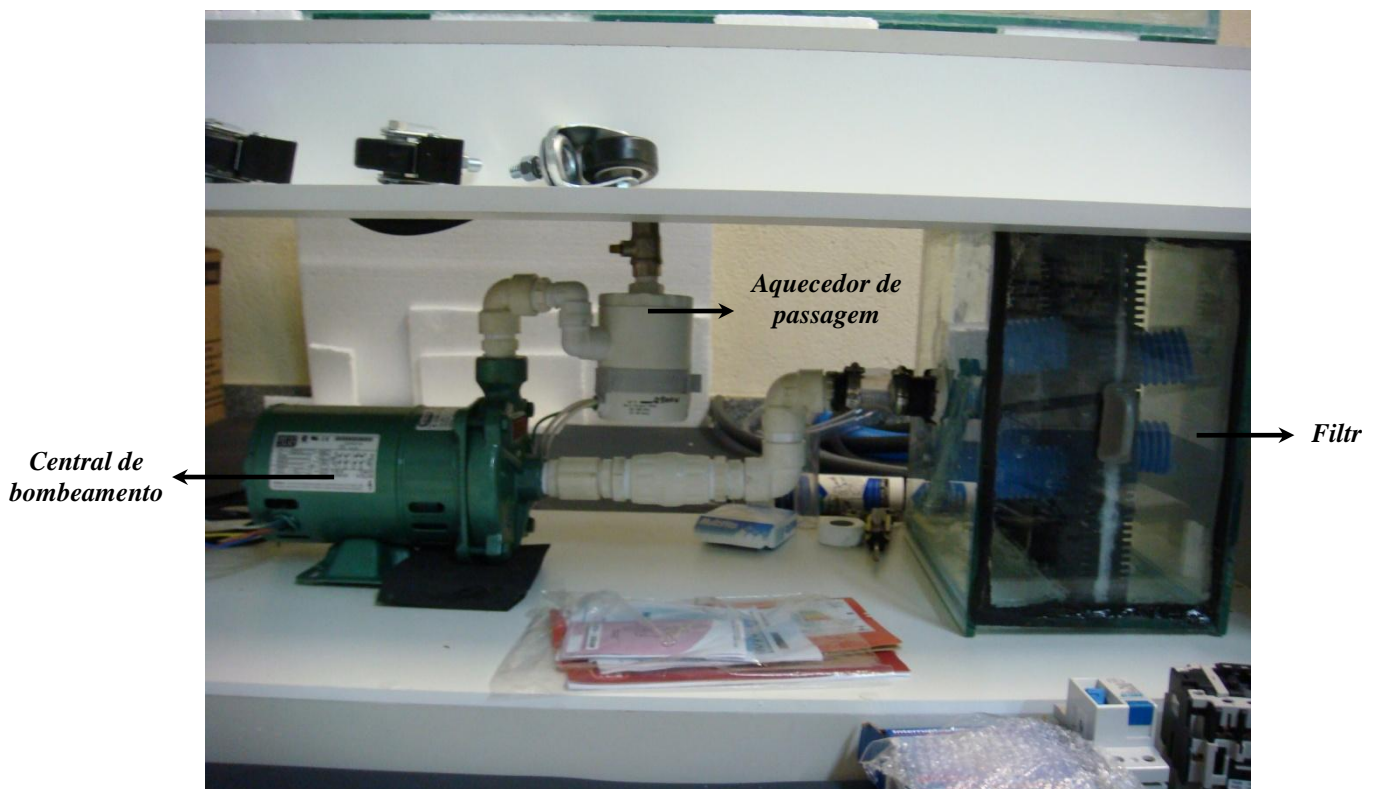
Figura 6: Vista anterior – Central de bombeamento, aquecedor de passagem e filtro
