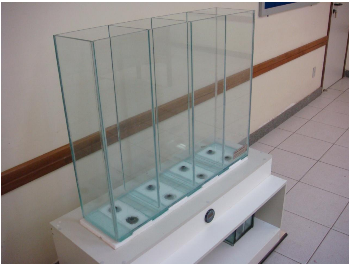
Figura 4 : Vista superior – Tanques, suporte de madeira, entrada e saída de água.
