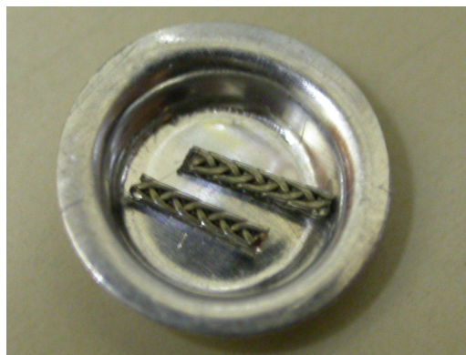
Figura 4.8 - Panela sem tampa com fragmentos de amostras utilizada no grupo de fios não deformados.
