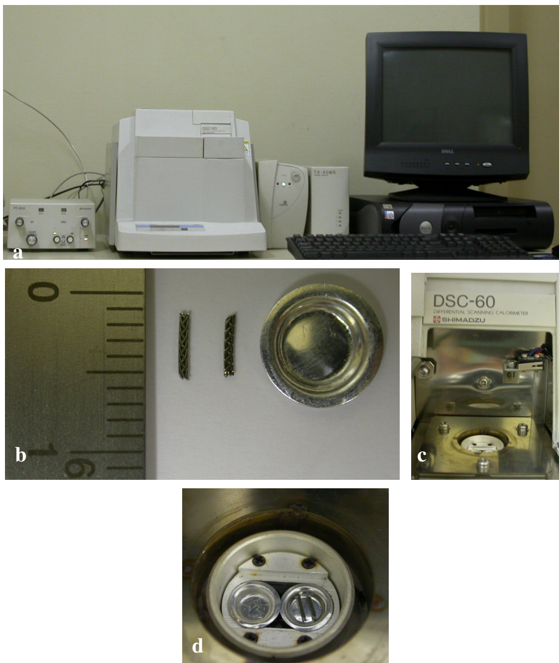
Figura 4.7 - a) Aparelho Shimadzu DSC 60 com computador acoplado; b) Preparo da amostra; c) Compartimento dos termopares; d) Termopares, panela de referência e da amostra.
