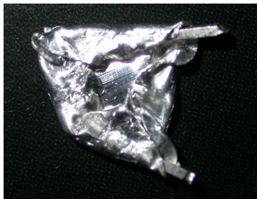
Figura 4.9 - Fio ativado a aproximadamente 135^\circ em panela de alumínio fechada utilizada no grupo de fios dds.
