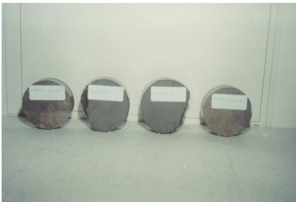
Figura 5.3 – Amostras utilizadas para o ensaio de tração.
