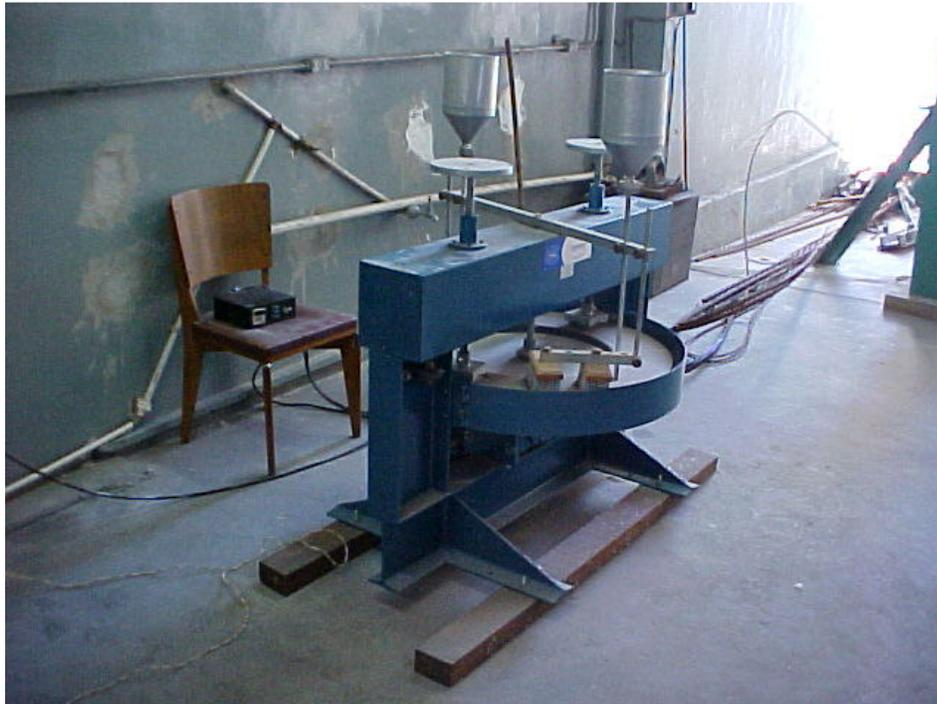
Figura 4.1 – Máquina de ensaio de abrasão Asmler.
