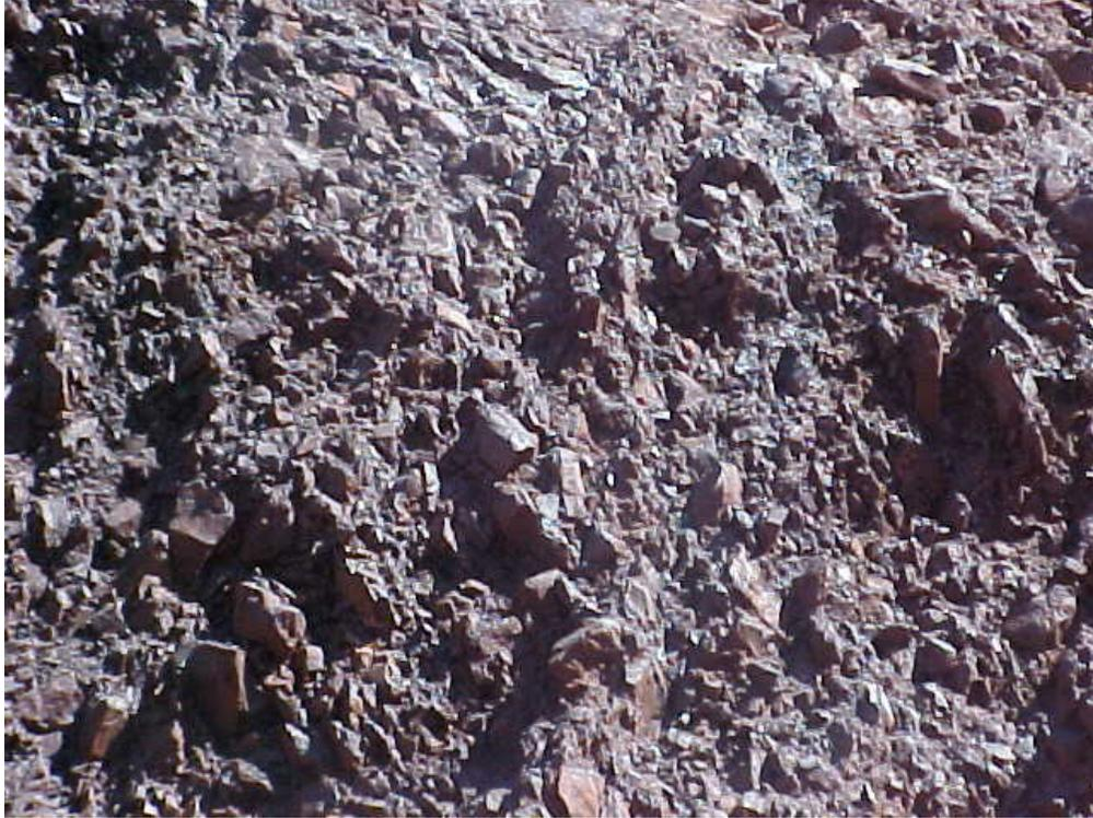
Figura 5.10 – Talude de hematita compacta, extremamente fraturada.
