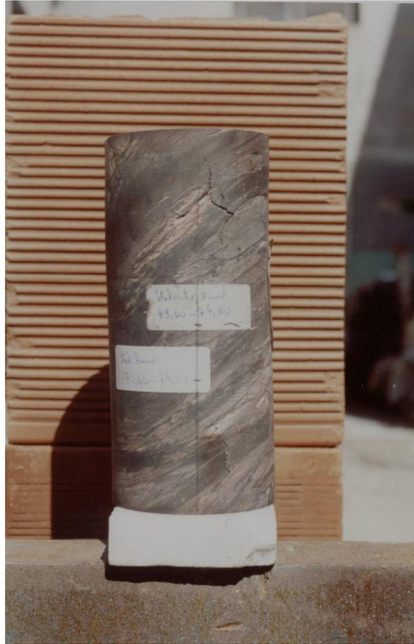
Figura 5.2 – Corpo de prova para ensaio de compressão uniaxial.
