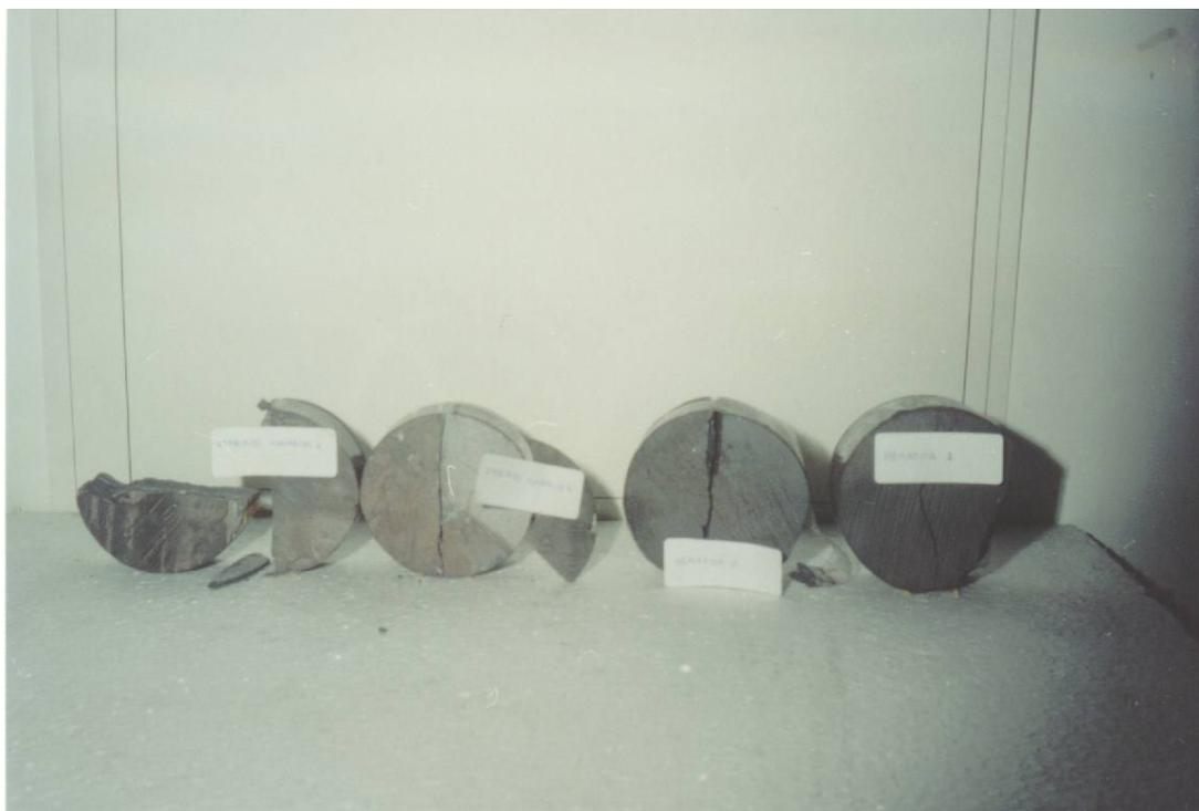
Figura 5.4 – Amostras após o ensaio de tração.
