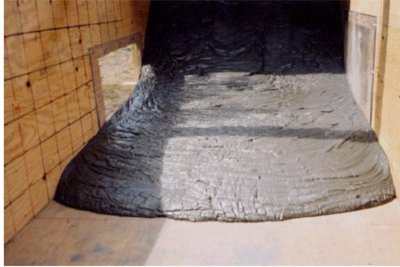
Figura 3.16: Teste de “flume” para uma pasta com "slump" de 71,12mm (2,8").
