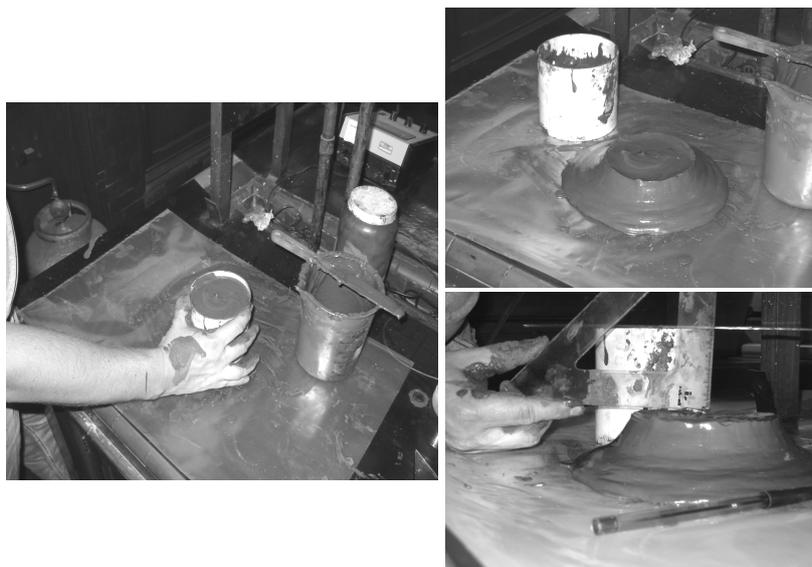
Figura 4.7: Testes preliminares de cilindro "slump" com pasta de 72,5% de sólidos.
