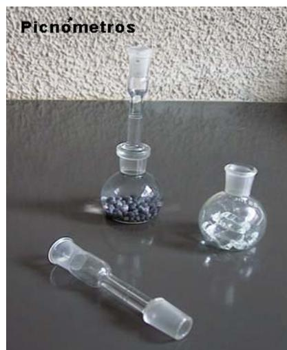
Figura 4.2: Picnômetros de laboratório. ([www.particletechlabs.com](http://www.particletechlabs.com))
