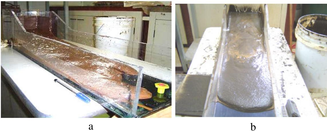
Figura 4.6: Fotografias da calha construída em acrílico. Vista: a) isométrica; b) superior.
