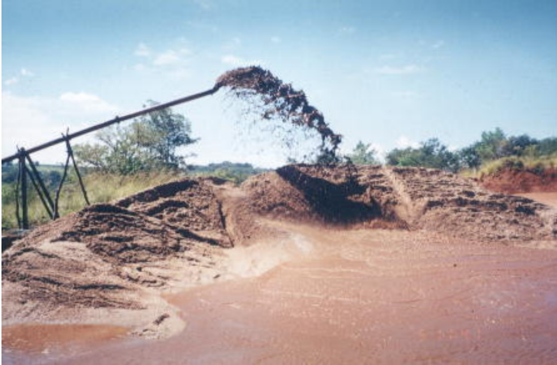
Figura 4.2 - foto 1 - Ponto de descarga da areia para a lavagem.
