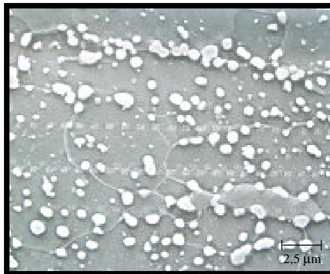
Figura 5-7 – Micrografia da amostra recozida por um tempo de 19 h a temperatura de 670°C, obtida por MEV.
