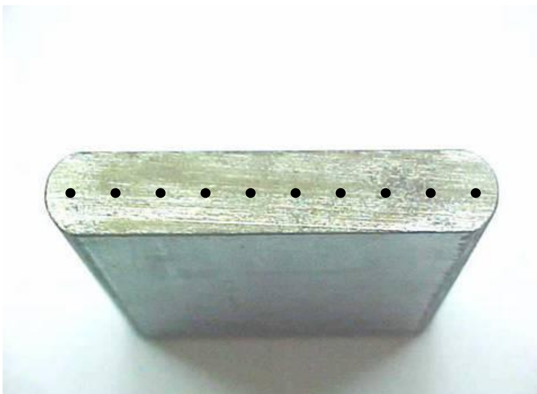
Figura 4.4 – Indicação da região onde foram realizadas medições de dureza.
