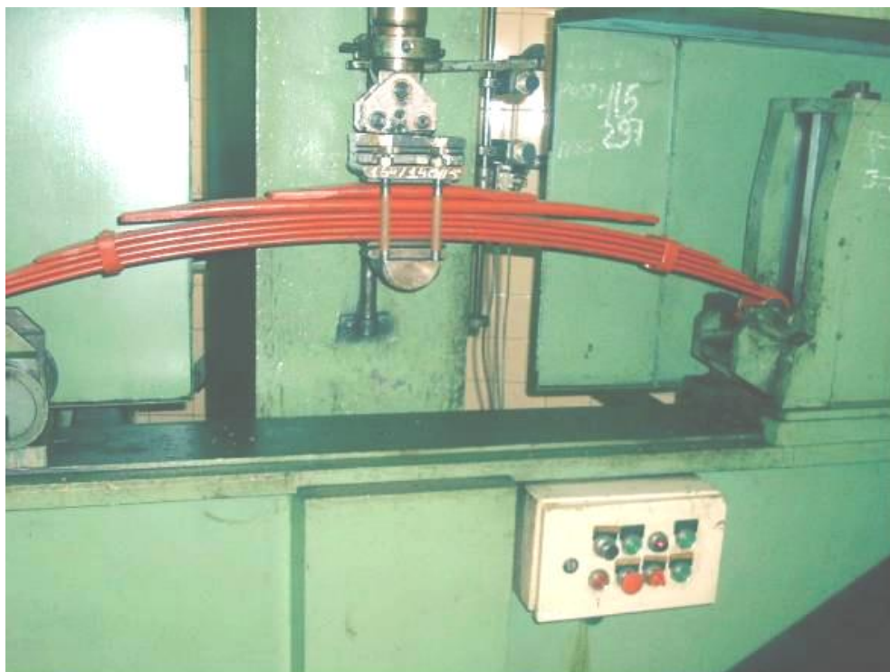
Figura 4.5 – Feixe de molas montado em máquina para ensaio de fadiga (Fonte: Cindumel – Indústria de Molas – SP).
