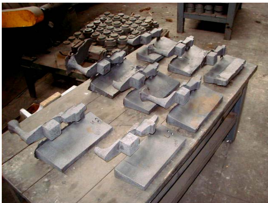
Figura 38 – Blocos Y com canais obtidos pelo processo de nodularização “ In mold ”.
