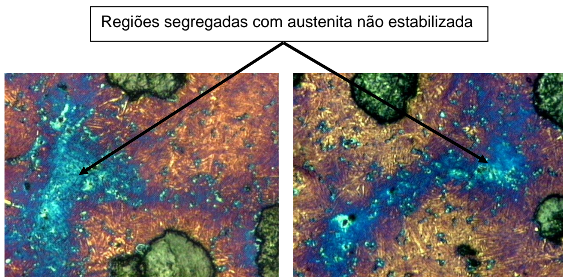
Figura 62 – Fotomicrografias de uma amostra com 87 nódulos/mm 2 apresentando as regiões segregadas entre os nódulos de grafita com austenita não estabilizada. Microscopia óptica. Ampliação 500X.
