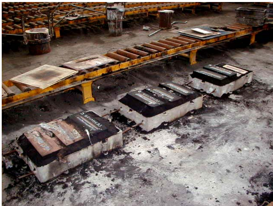
Figura 39 – Blocos Y obtidos pelo processo de nodularização “Sanduíche”.
