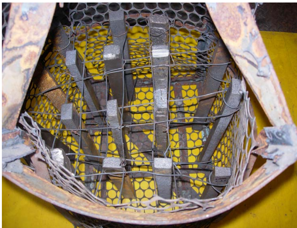
Figura 40 – Posicionamento e fixação das barras de 17 X 25 X 330mm dentro do cesto de tratamento térmico.
