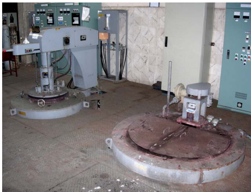
Figura 41 – Forno de austenitização e forno de banho de sais.
