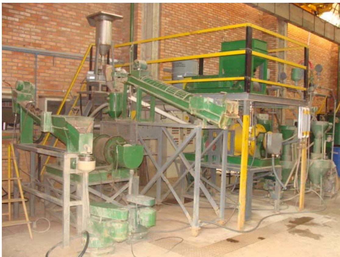
Figura 4.3 - Circuito piloto de moagem e deslamagem utilizado.
