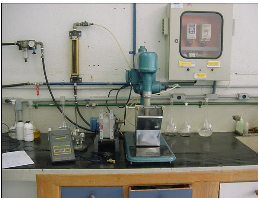
Figura 4.4 - Montagem utilizada para realização dos testes de flotação em laboratório.
