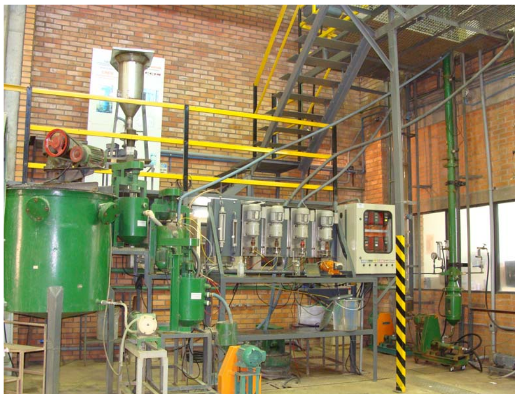
Figura 4.6 - Unidade de flotação em coluna utilizada para realização dos testes piloto.
