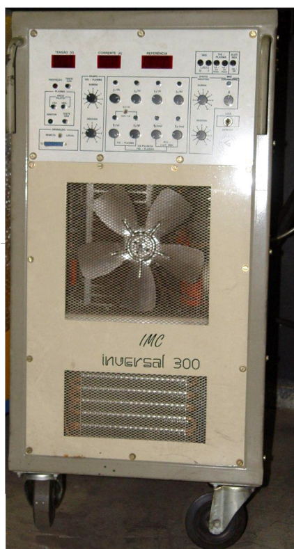
Figura 4.1 - Fonte eletrônica multiprocessos INVERSAL 300 da IMC
