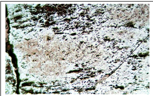
Fotomicrografia 4.10 – Amostra 2 – Cristal de magnetita (mt) intensamente martitizado sendo observados apenas alguns relictos. Aumento de 320x – LRP – nicóis descruzados
