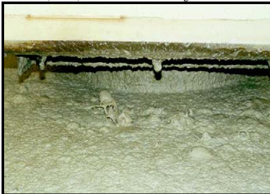
Foto 2.6 – Célula de flotação: concentrado apatítico do circuito de minério granulado.
