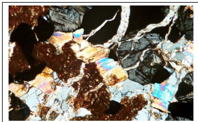
Fotomicrografia 4.20 – Amostra 3 – Cristal de piroxênio (px) cortado por abundantes vênulas de carbonato (cb). Note exsoluções de minerais opacos – Aumento de 50x – LTP – nicóis cruzados
