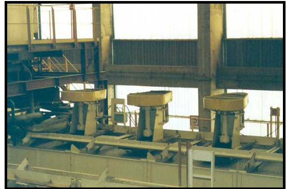
Foto 2.5 – Flotação cleaner do circuito de minério granulado.
