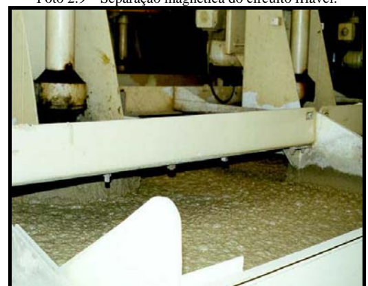
Foto 2.11 – Célula de flotação: concentrado apatítico final.
