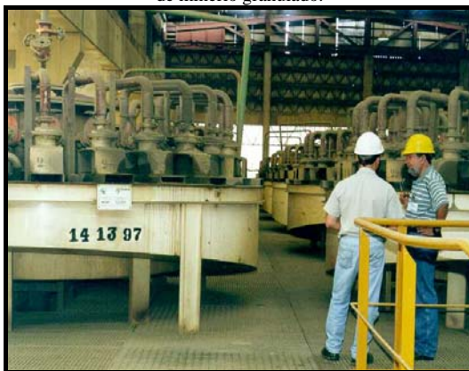
Foto 2.8 – Deslamagem do minério friável.
