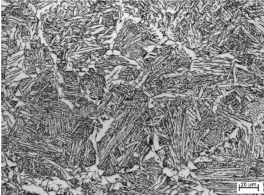
**Figura 5.14:** Microestrutura da GGZTA do aço USISAC350, 16,0 mm de espessura. Aporte de 1,2 kJ/mm. Aumento original 500X. Constituintes: Ferrita pró-eutetóide, ferrita com MAC, ferrita de Widmanstätten intragranular e agregados ferrita-carbeto.
