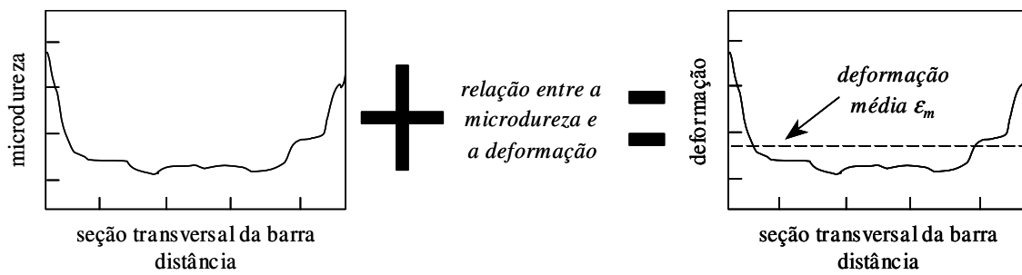
Figura 3.4 – Representação esquemática do método do perfil de dureza.
