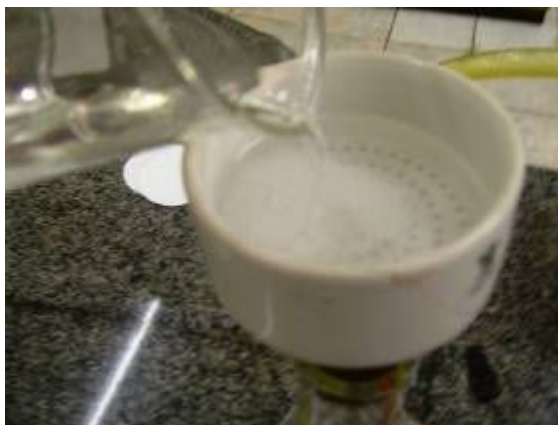
Figura 4.15: Filtragem à vácuo da solução de N-IPAAm em n-hexano.
