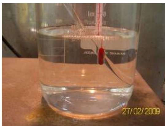
Figura 4.14: Dissolução total de N-IPAAm em n-hexano a 60°C.
