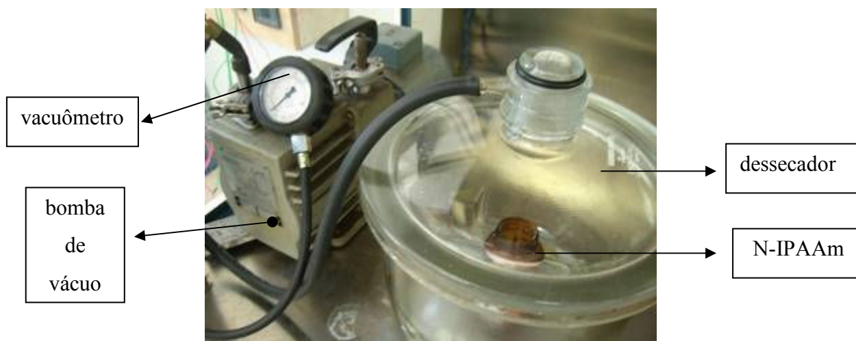
Figura 4.18: Sistema de secagem à vácuo de N-IPAAM.
