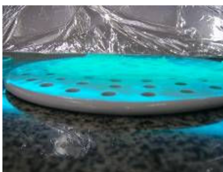
Figura 4.23: Filme de PU exposto ao UV.
