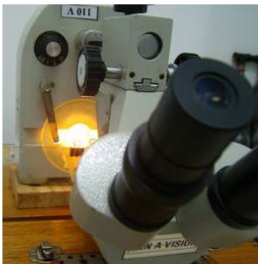
Figura 4.27: Lupa para observação do ângulo de contato
