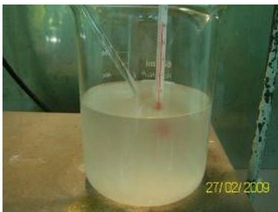
Figura 4.13: Dissolução de N-IPAAm em n-hexano com aquecimento e agitação.
