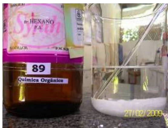
Figura 4.12: N- hexano adicionado ao n-isopropilacrilamida (N-IPAAm).
