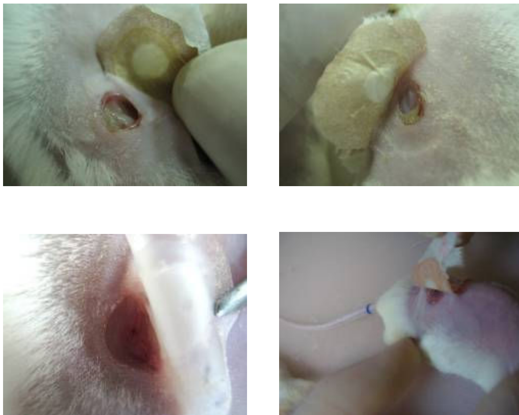
Figura 5.27: Testes on-off para verificação de aderência do tecido na superfície dos materiais.
