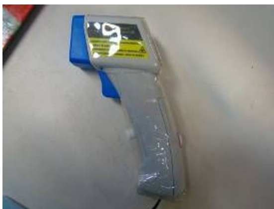
Figura 4.38: Termômetro à laser para leitura da temperatura da pele.
