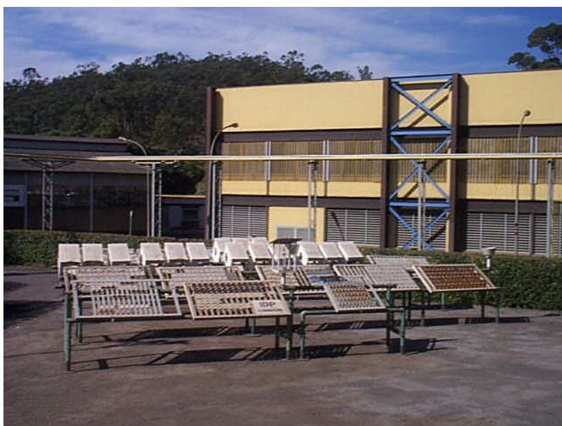
Figura 4.4 - Estação de corrosão para a realização do ensaio de campo com aspersão de solução salina, segundo a norma ISO 11.474 (1993).
