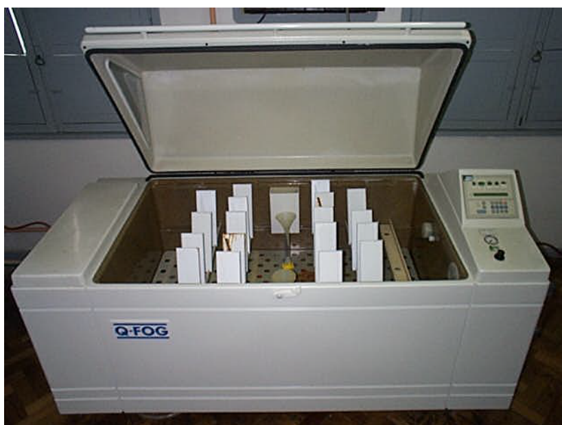
Figura 4.3 - Equipamento Q-Fog fabricado pela The Q-Panel Company.
