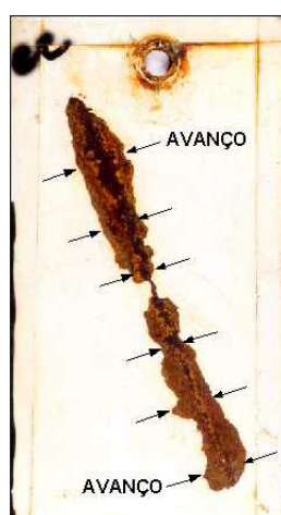
b) avanço médio da corrosão
