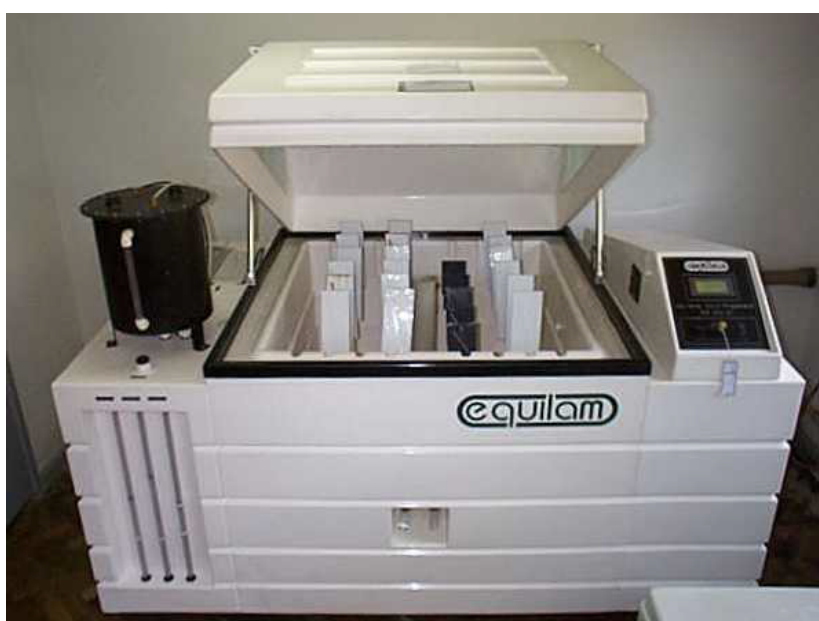
Figura 4.2 - Equipamento Equilam - SSE 1000 Cíclico.
