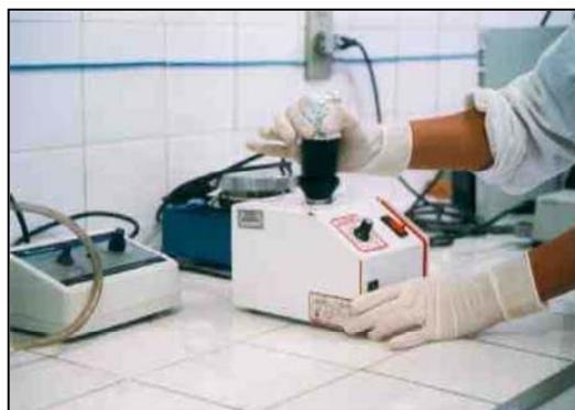
Figura 4.23 – Homogeneização da amostra com Vortex.
