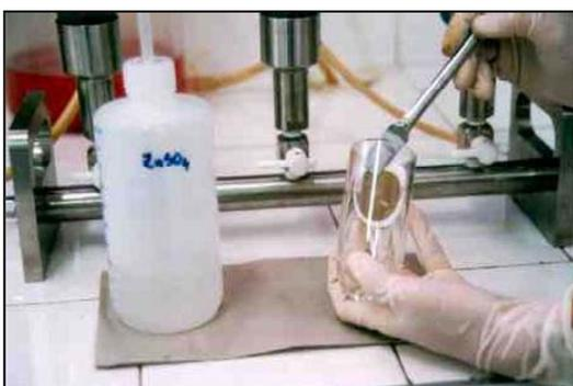
Figura 4.30 – Transferência do material (ovos) para o tubo da centrífuga. (procedimento “b” do item 4.6.6)
