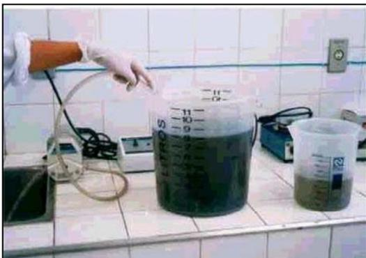
Figura 4.7 – Remoção do sobrenadante após o período de sedimentação (procedimentos "b" e "c" do item 4.3.5)
