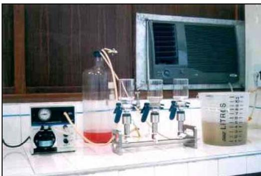
Figura 4.28 – Filtração de 1 L da amostra em membrana de 47 mm e 8 µm. (procedimento “a” do item 4.6.6)
