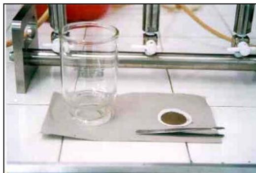
Figura 4.29 – Membrana contendo material filtrado (ovos).
