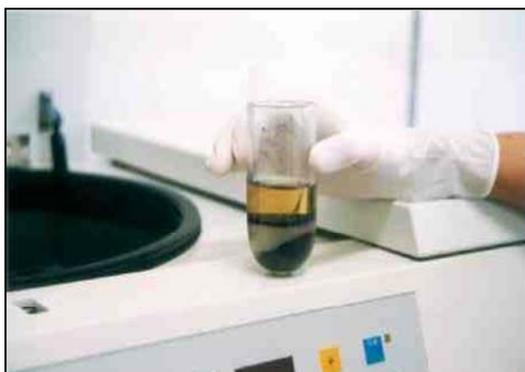
Figura 4.9 – Separação de Fases da amostra (procedimento "i" do item 4.3.5)
