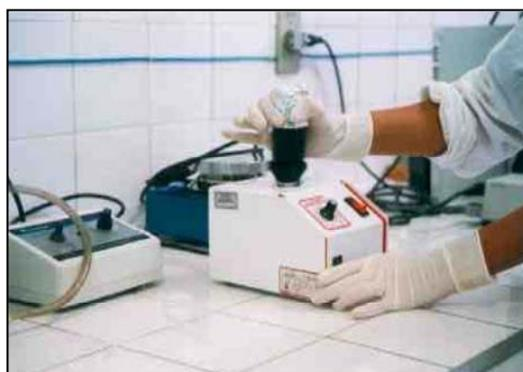
Figura 4.10 – Homogeneização da amostra c/ Vortex (procedimentos "h" e "k" do item 4.3.5)
