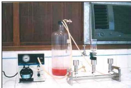
Figura 4.25 – Filtração do sobrenadante em membrana de 25 mm e 8  $\mu$ m.
