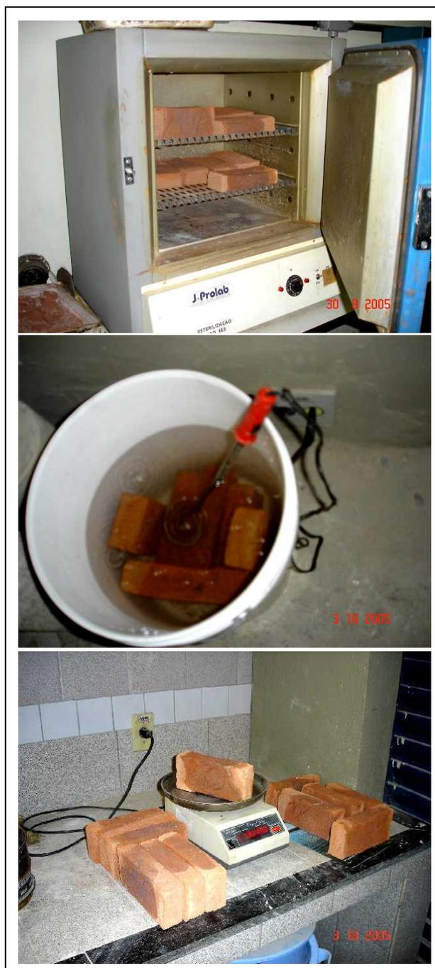
**FIGURA 4.9** – Fases do ensaio de absorção de água
