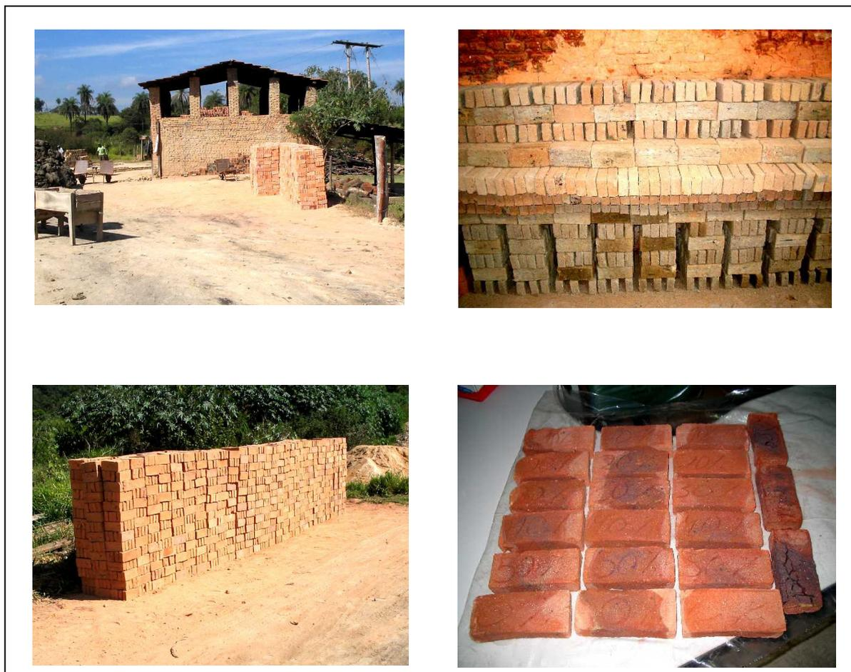
**FIGURA 4.7** – Fotos do forno (externa e interna) e dos tijolos pós-cozimento
