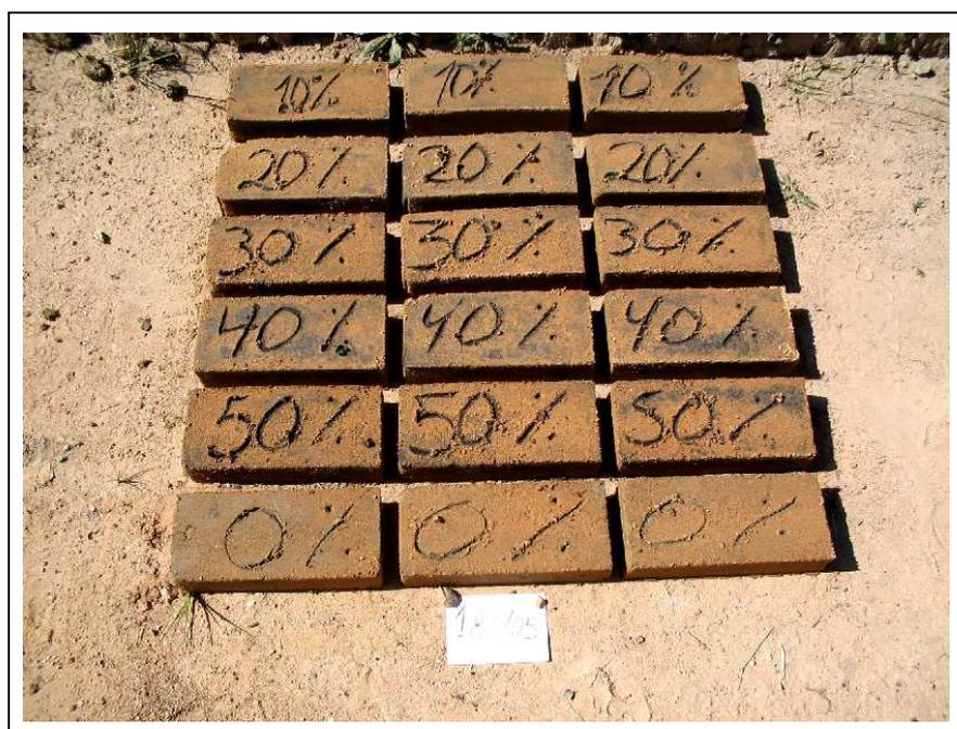
**FIGURA 4.5** – Tijolos após conformação e identificação
