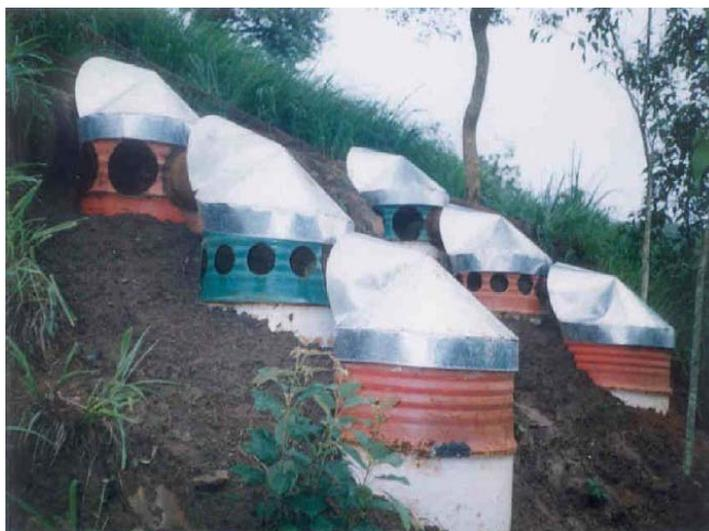
**FIGURA 3.8** – Método da chuva natural para avaliação de perda de solo por sistemas de coletores
