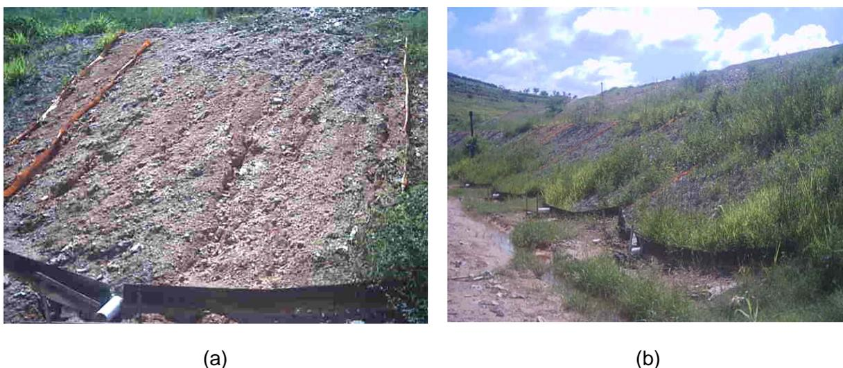
**FIGURA 4.7** – Detalhes dos canalizadores de sedimento: (a) parcela individual com o canalizador na base do talude; (b) canalizadores ao longo das parcelas no talude.
