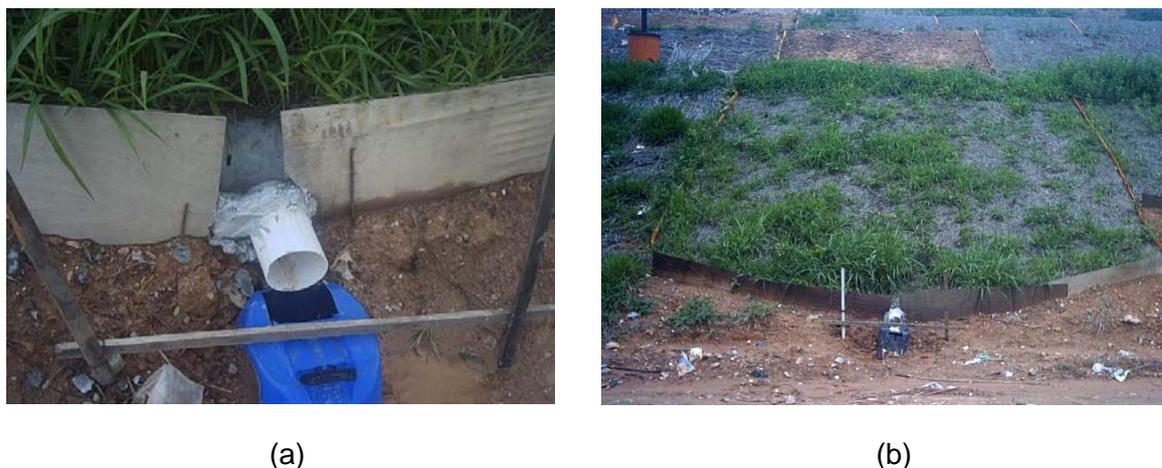
**FIGURA 4.10** – Detalhe do coletor de sedimento: (a) conexão dos conjuntos de coletores (canalizador + tubo + coletor); (b) coletor na base da parcela.
