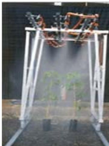
**FIGURA 3.9** – Método artificial de avaliar perda de solo através do simulador de chuva
