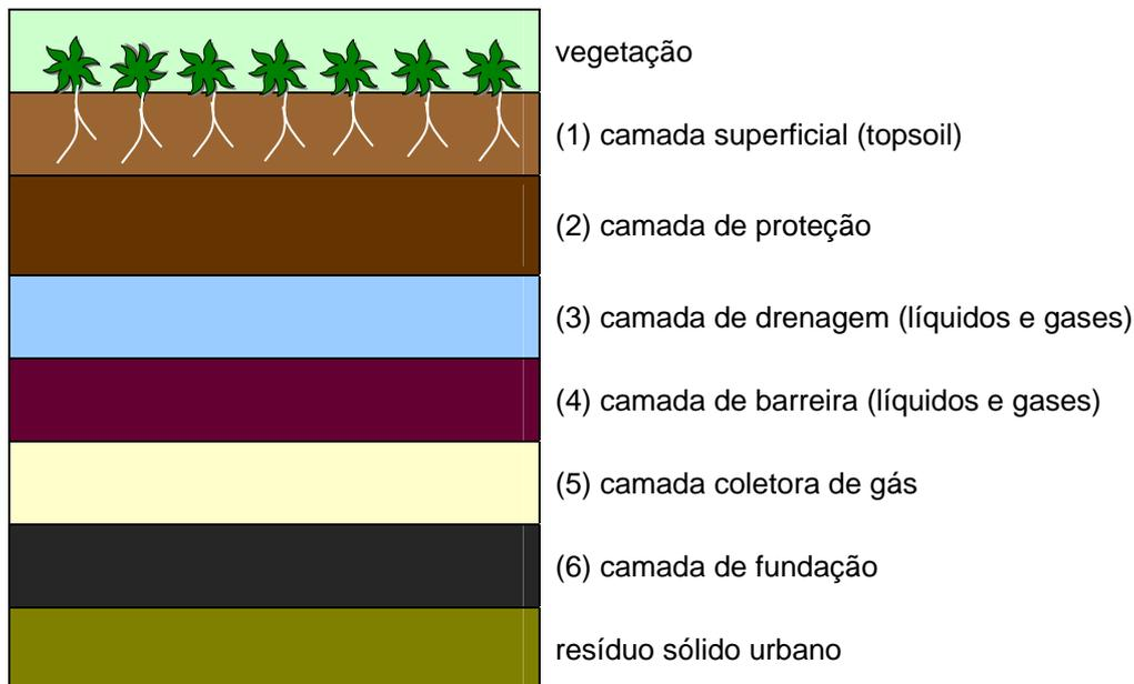
**FIGURA 3.2** – Configuração típica da camada de cobertura final de ADRSU
