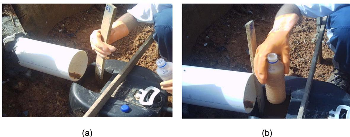
**FIGURA 4.8** – Coleta da perda de solo: (a) medição do volume; (b) coleta da alíquota.
