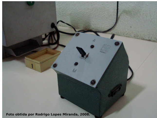
FIGURA 8 – Detalhe do controlador da caixa de Skinner da FUNBEC no LabAC/UFMG [2008].
