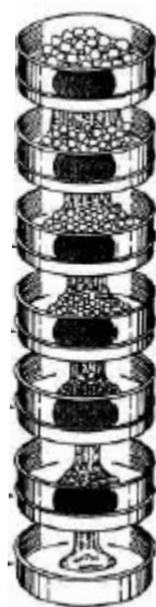
Figura 6.1 - Exemplo de uma série de peneiras padronizadas para peneiramento
