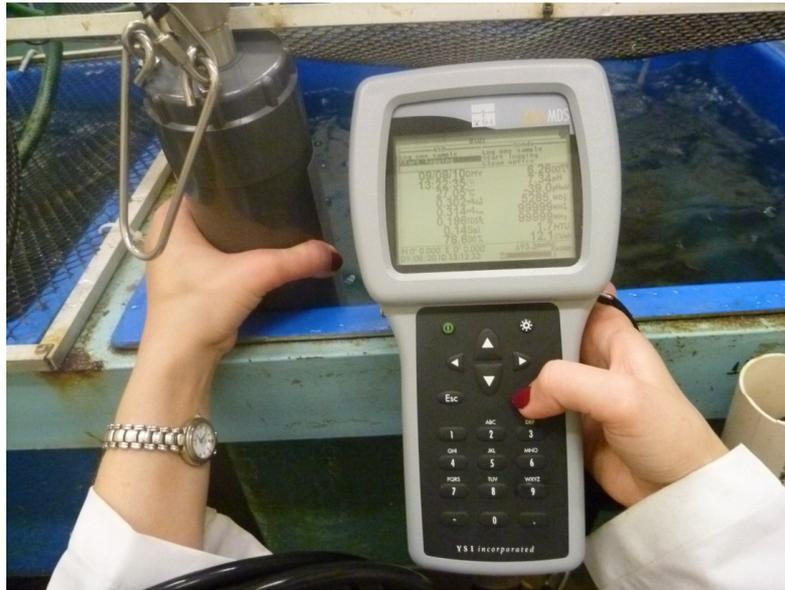
Figura 3. Medição dos parâmetros de qualidade de água pela sonda multiparametros.
