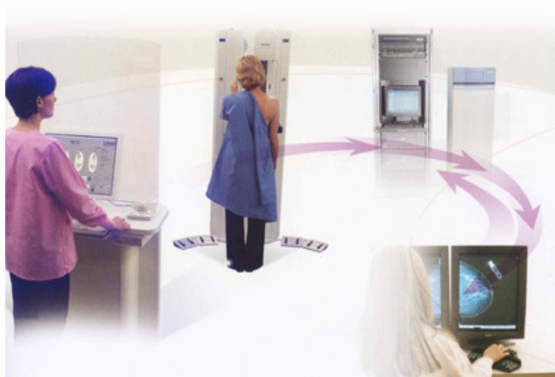
Figura 4.4 – Fluxo das Imagens do mamógrafo. (Fonte: Hologic 2010)
