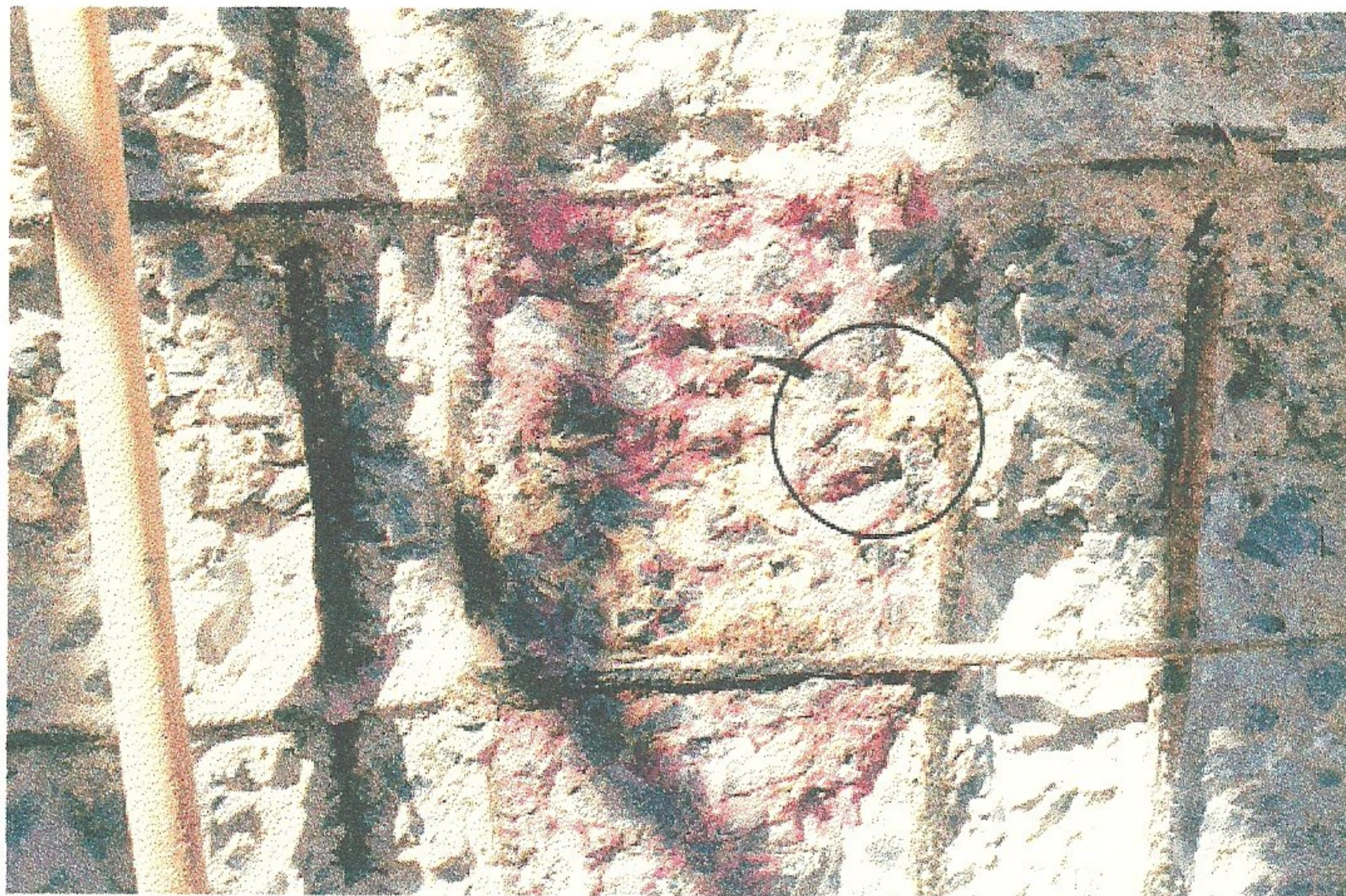
Figura 2.55 - Aplicação de fenolftaleína em um pilar carbonatado. [24]
