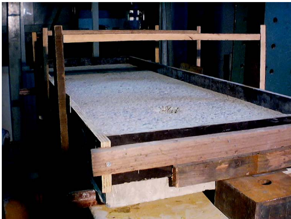
FOTO 5.1 – Detalhe da superfície superior da laje após o apicoamento
