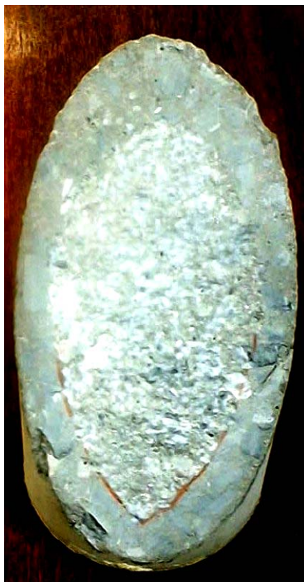
FOTO 4.2 – Corpo-de-prova serrado e apicado
