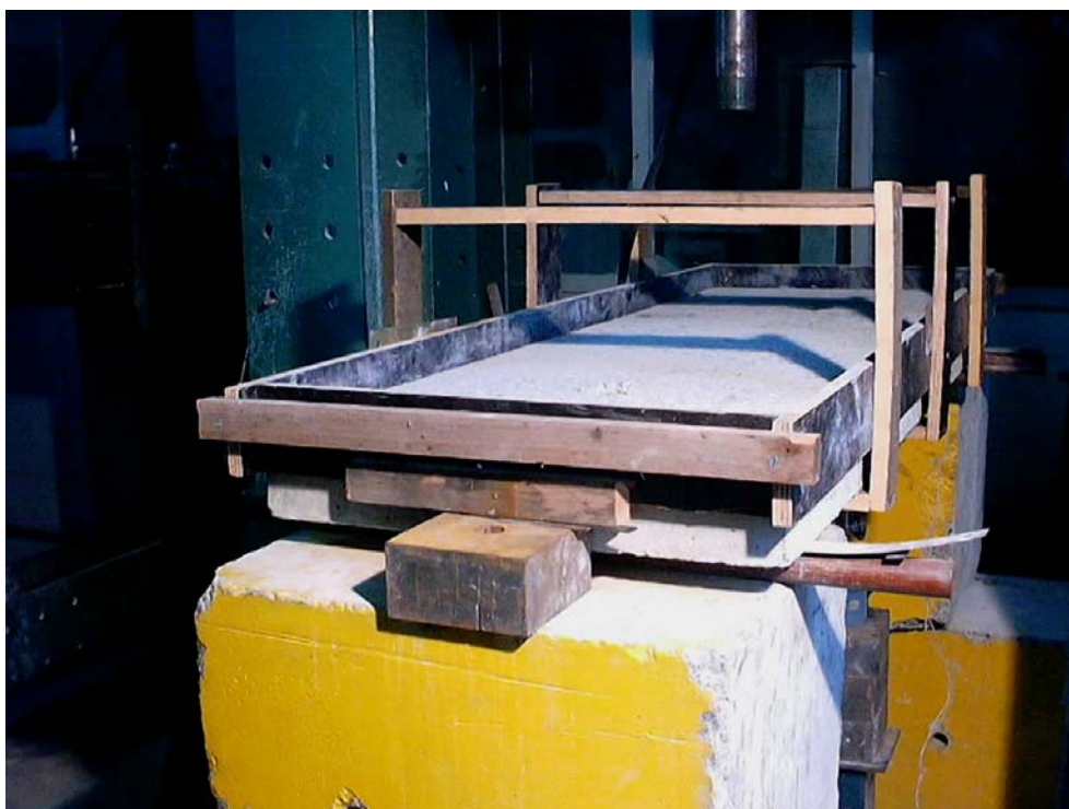
FOTO 5.2 – Detalhe da fôrma para a execução do reforço
