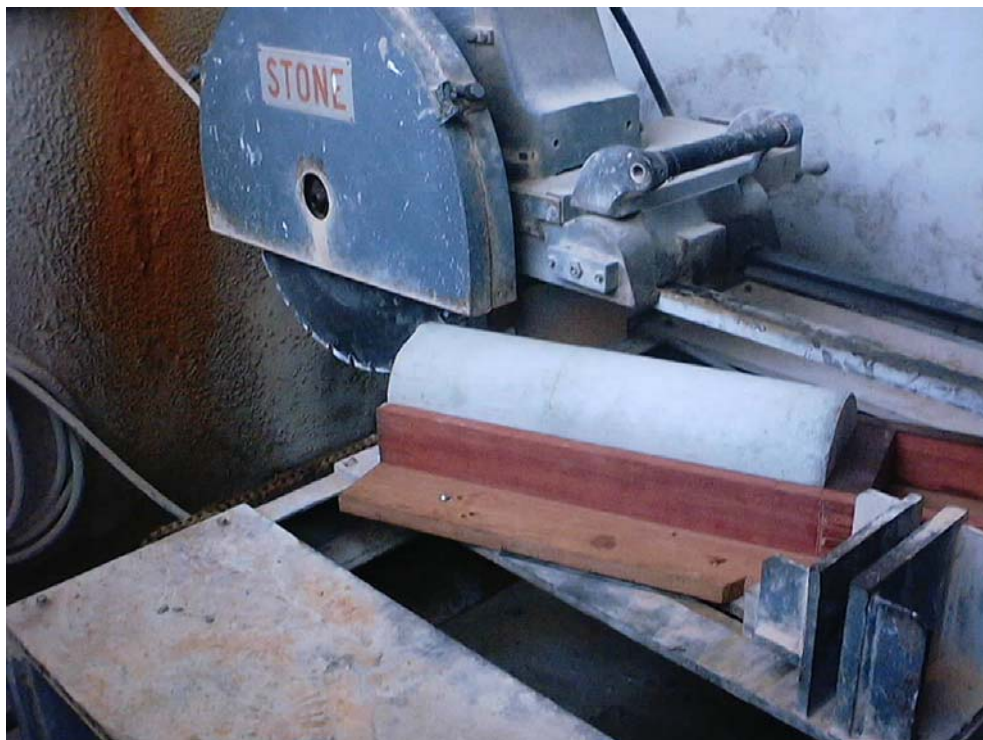
FOTO 4.1 – Detalhe do corte de um cilindro de 15 x 50 cm
