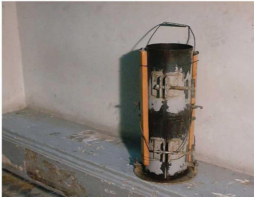
FOTO 4.5 – Fôrma utilizada para concretagem dos CP's cilíndricos de 15 x 50 cm
