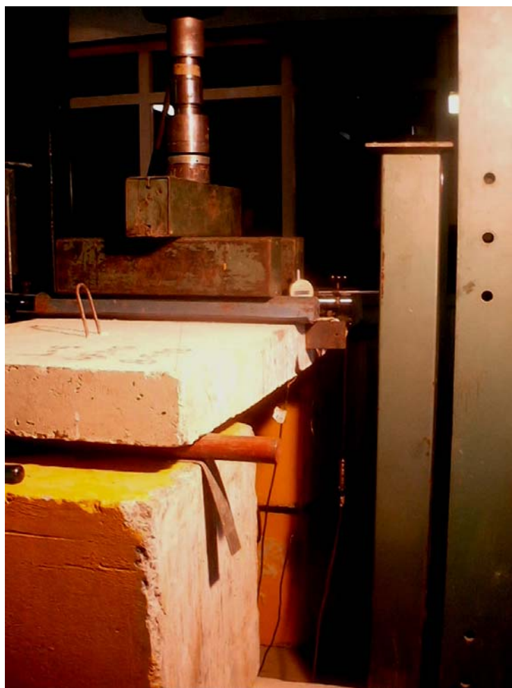
FOTO 5.3 – Esquema de carregamento das lajes
