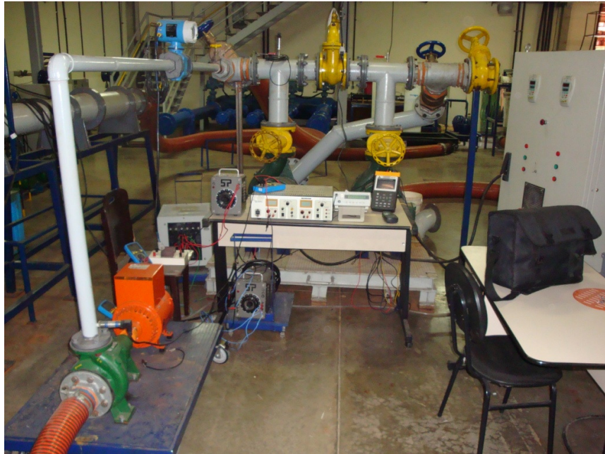
Fig. B.1. Bancada de testes do grupo gerador.
