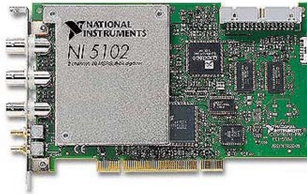
Fig. 3.5 – Placa de aquisição igual à utilizada no projeto
