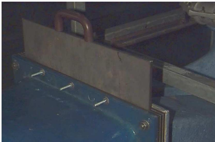
*Figura 3-2. Barreira mecânica instalada na saída da sucção de aparato experimental.*
