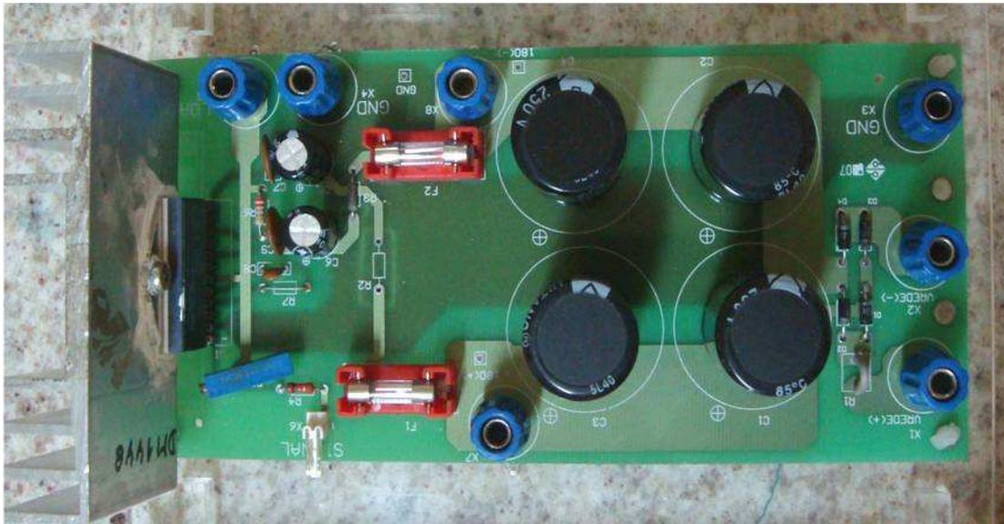
Figura 4-7. Amplificador montado para os testes de 50, 1000 e 10000Hz.
