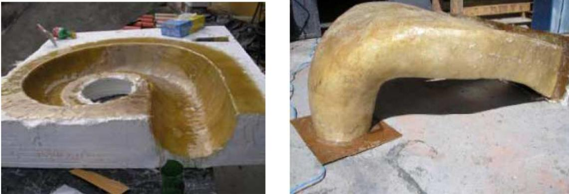
*Figura 4-13. Laminação com fibra de vidro dos modelos da caixa voluta e tubo de sucção.
