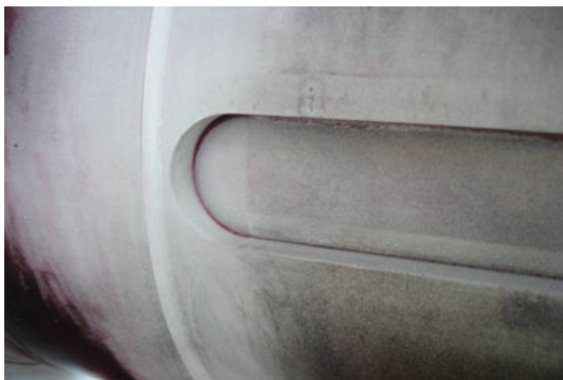
FIGURA 2.16 - Detalhe do rasgo de chaveta do eixo de mandril, similar ao que sofreu a fratura (Fonte: GUIMARÃES, 2009).
