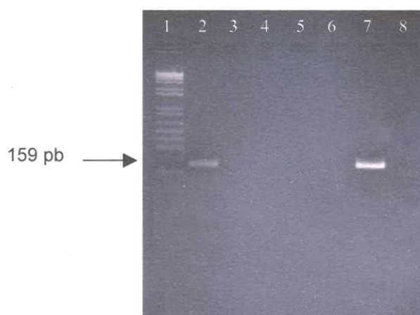
Figura 1. Eletroforese em gel de agarose a 2%. Canaleta 1. Marcador de peso molecular 1kb plus DNA Ladder (Invitrogen, São Paulo, Brasil). Canaleta 2. Extrato de DNA de Clostridium chauvoei obtido a partir de cultura pura do tecido subcutâneo lesado. Canaletas 3, 4, 5 e 6: extrato de DNA de amostras de referência de Clostridium septicum , Clostridium sordellii , Clostridium novyi tipo A e Clostridium perfringens tipo A, respectivamente. Canaleta 7: controle positivo de C. chauvoei (ATCC 10092). Canaleta 8: controle negativo.
